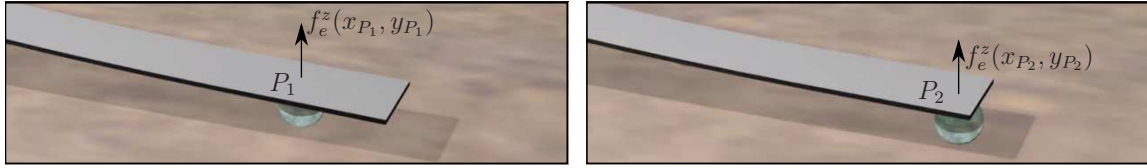
Figure 2.5 - Point d'application de la force pour une poutre sans pointe : sa position n'est pas fixe, et dépend de la position de l'objet.
