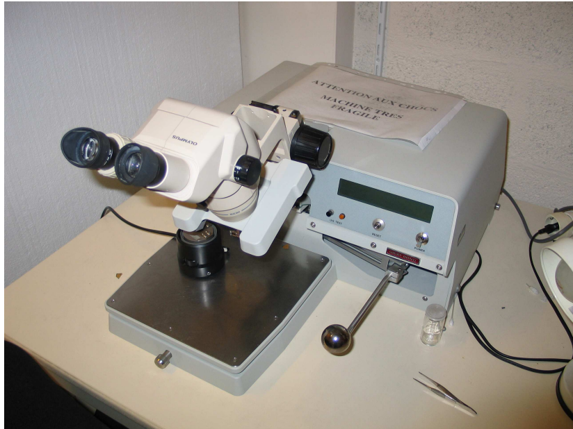
Appareil WESTBONDING permettant de réaliser les contacts électriques des échantillons
