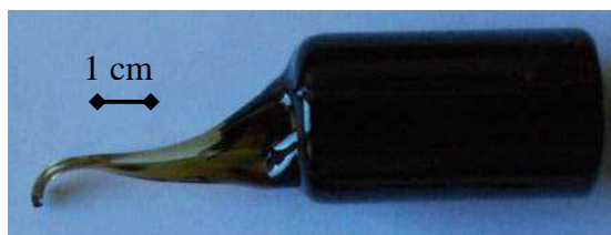
Figure 11 : Verre résiduel coulé dans un creuset graphite préchauffé à 520 °C.
