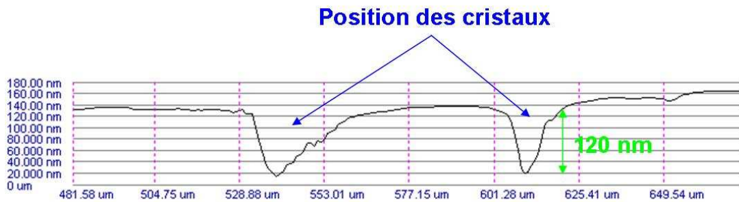
Figure 129 : Profil topographique de la surface saine de la vitrocéramique (mesure par interférométrie optique) montrant l'arrachage de la partie supérieure des cristaux lors du polissage.
