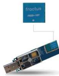
FIG. 2.12 – Antenne intégrée en module dédié soudé sur une clé USB WiFi
