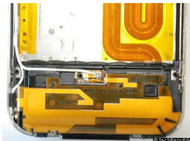
FIG. 2.4 – Antenne imprimée multi-bandes sur un PCB de téléphone portable
