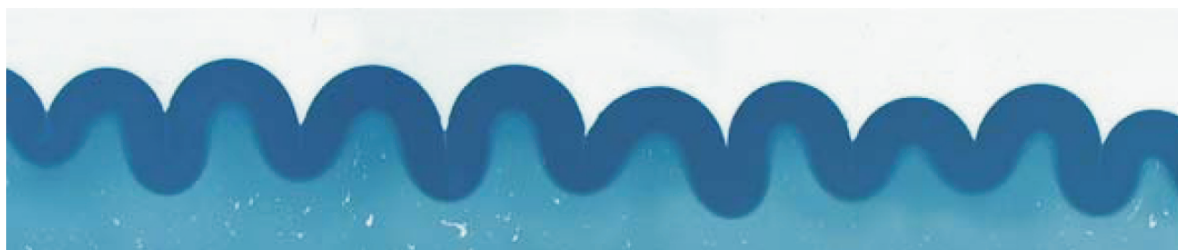
FIGURE 4.13 – Expérience de flambage de gel sur substrat mou. La figure est tirée de Sultan et Boudaoud (2008).
