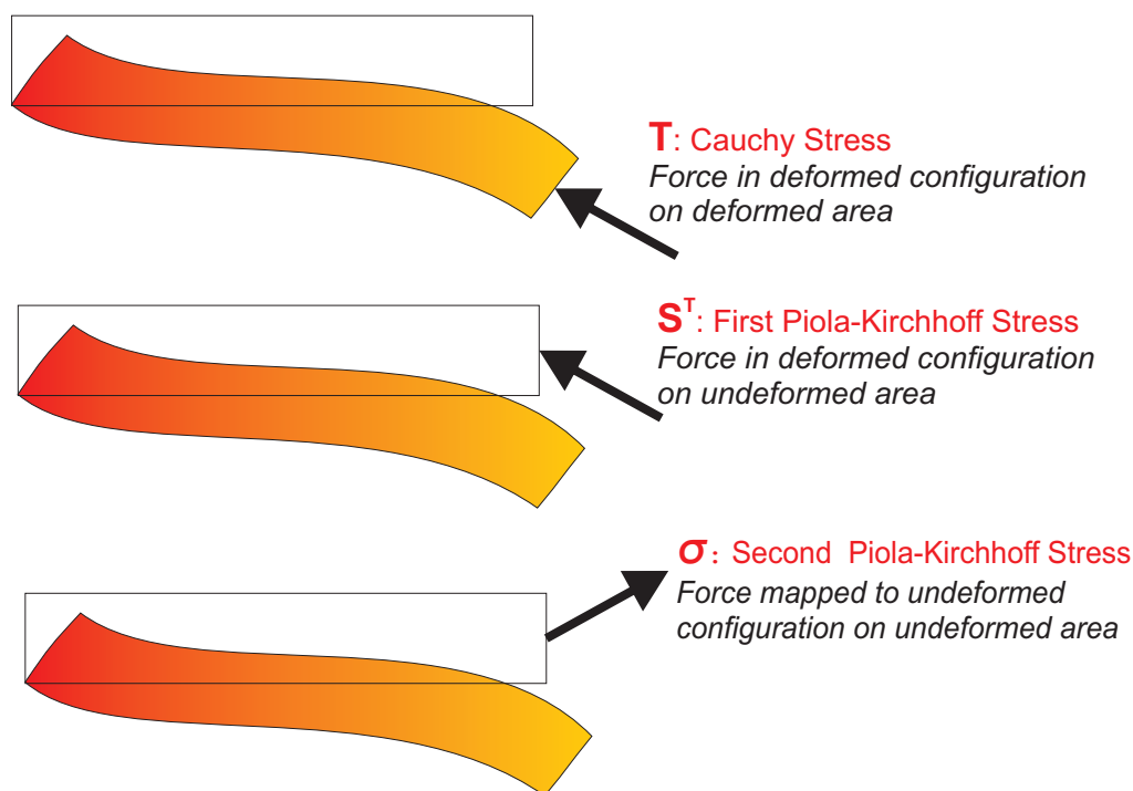
FIGURE 1.16 – Illustration schématique des différentes mesures du champ de contraintes. Le rectangle blanc indique la configuration initiale et la forme colorée indique la configuration courante.
