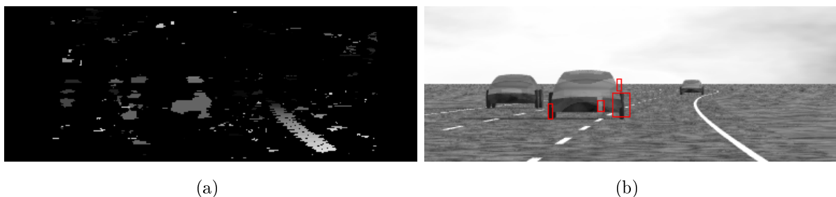
FIG. 4.21 : (a) Carte des disparités obtenues avec notre méthode 1D avec T_{dec} = 0.7 et une hauteur de fenêtre de 5 pixels, (b) Boîtes englobantes obtenues sur la carte des disparités (a) (ici, la caméra droite est sur-élevée de 5 cm).
