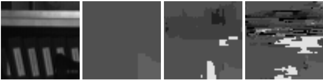
FIG. 2.13 : Comparaison qualitative de résultats de disparité obtenus pour la sous-image (A) par la mesure SSD (Sous-image (A) - Vérité-terrain associée - Disparités obtenues avec une fenêtre carrée 11 \times 11 - Disparités obtenues avec une fenêtre ligne 11 \times 1 ).
