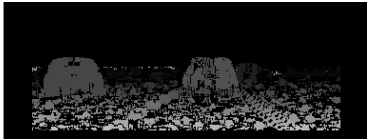
(a) Carte des disparités obtenues avec la méthode de Hirschmüller (fenêtre de taille 7 \times 9 )
