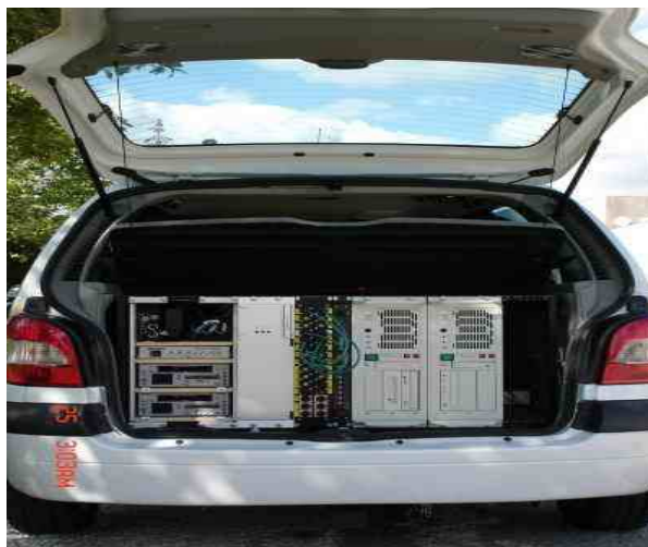
Illustration 3.11 : Ordinateurs embarqués permettant d'effectuer l'enregistrement des données.
