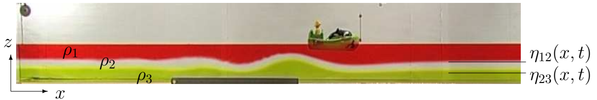
FIGURE 7.26 – Photos illustrant le phénomène d’eaux mortes dans le cas d’un fluide à trois couches.
