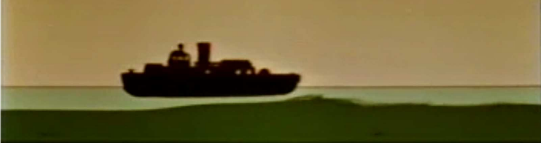
FIGURE 7.1 – Principe illustrant le phénomène d’eaux mortes, extraite du film Stratified Flow [69]. L’eau douce et l’eau salée sont respectivement vert clair et vert foncé.
