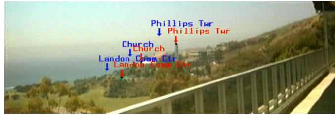
FIG. 3.3: Exemple d'annotations dans un environnement extérieur [You et al., 1999] : avec les données inertielles sans correction (en bleu) et avec correction en utilisant la vision (en rouge)
