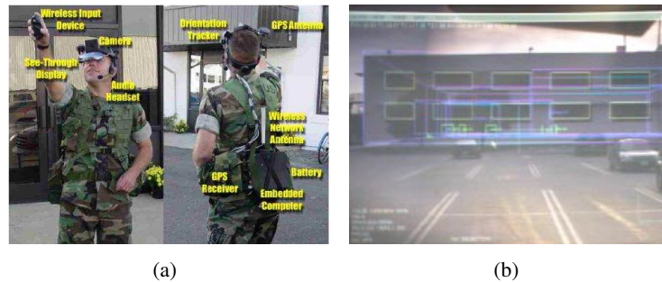
FIG. 1.16: Le prototype BARS testé par un militaire [Julier et al., 2000] (a) Plate-forme matérielle (b) Exemple d'augmentation
