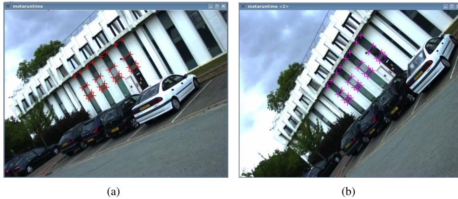
FIG. 5.5: (a) Image de référence (b) Projection des points avec l'homographie calculée
