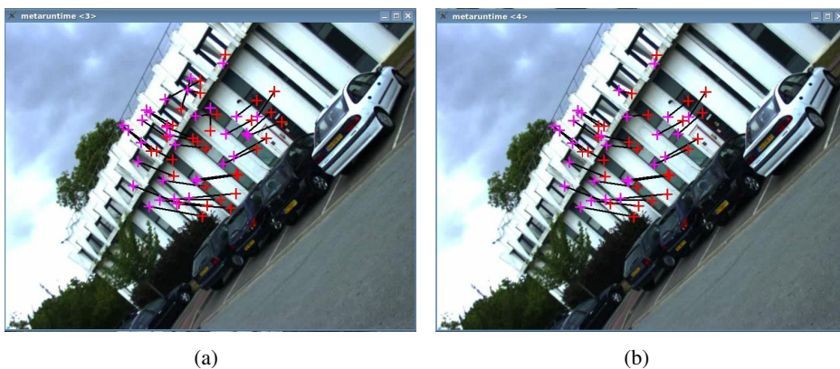
FIG. 5.3: (a) Les appariements des points SURF (b) Suppression des outliers avec le calcul de l'homographie
