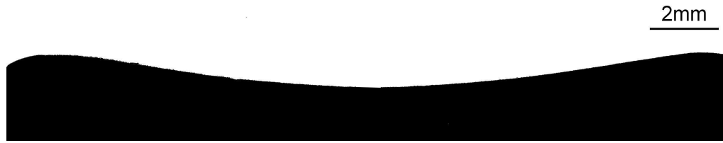
FIGURE 3.3 – Front de fissure se propageant dans une interface PDMS-Verre homogène. La forme du front est la conséquence des effets de bord (effet anticlastique).
