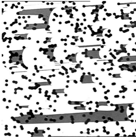
FIGURE 3.7 – Substrat de verre texturé après pelage (taille de l'image : 1mm). Un traitement des surfaces au plasma à oxygène avant collage provoque un transfert de matière : des lambeaux de PDMS restent collés sur le verre. Ce traitement ne sera par utilisé dans la suite.
