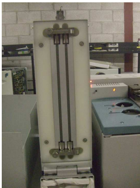
Photographie 6 : Intérieur de la deuxième étuve contenant deux colonnes en verre.
