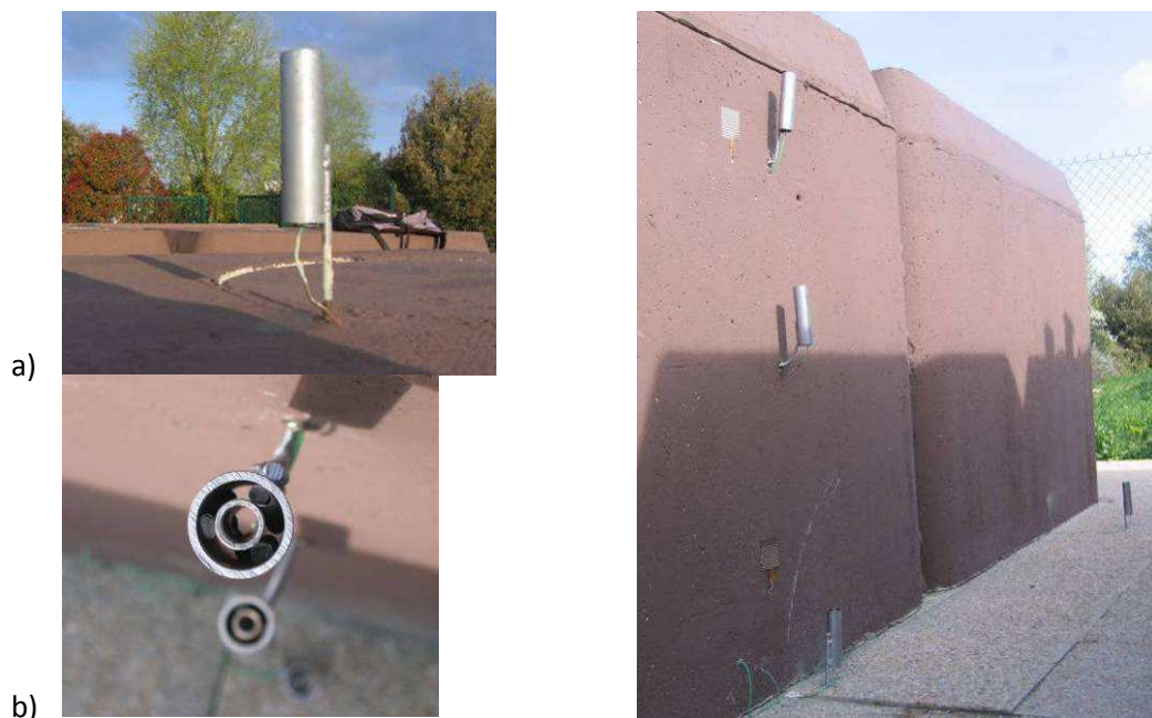
Figure 73: tube basse émissivité de protection pour thermocouples air
