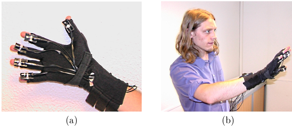
FIGURE 4.11 – Gant à retour vibro-tactile développé au LISA : (a) placement des moteurs sur le 5DT Data Glove 14 ddl et (b) utilisateur en situation de test de perception.
