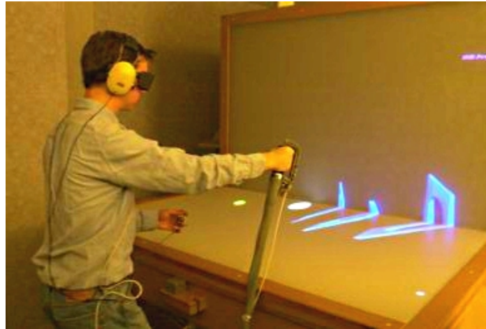
FIGURE 2.24 – Configuration visuo-haptique basée sur un plan de travail et la poignée W2H .
