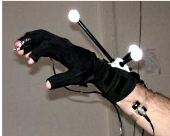
FIGURE 5.9 – Gant de données 5DT Data Glove 14 ddl équipé d'un vibro-moteur et de réflecteurs infrarouges. Un autre vibro-moteur a été placé sur l'avant-bras de l'opérateur.
