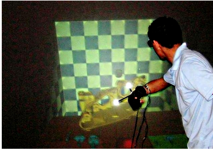
FIGURE 5.13 – Sujet réalisant la tâche de maintenance en utilisant le système de capture par caméras infrarouges et le gant de données 5DT Data Glove 14 ddl .
