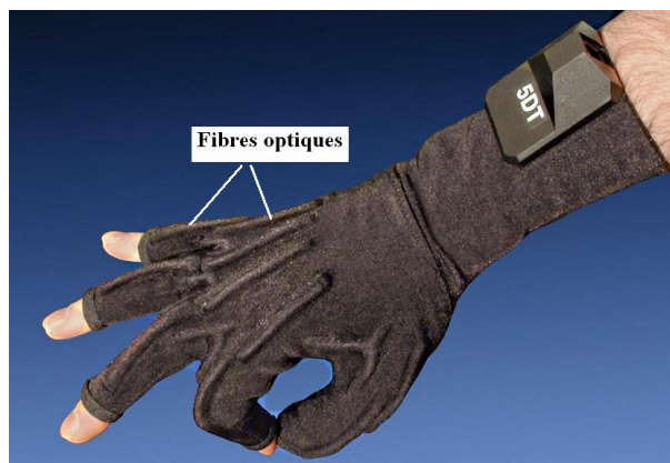
FIGURE 4.10 – Illustration du gant de données 5DT Data Glove 14 ddl .
