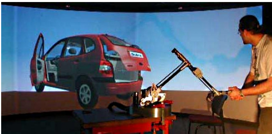
FIGURE 2.28 – Exemple de configuration visuo-haptique utilisant une salle immersive et l'interface série Virtuose TM .
