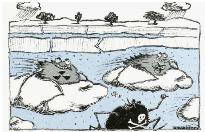
Figure 1 : Représentation schématique du transport facilité dans un aquifère (McCarthy et Zachara, 1989)
