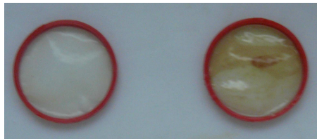
Figure 40 : Filtres de colonne traversés par les particules F110 à gauche et par les particules P100 à droite. La taille et le potentiel zêta des particules est approximativement le même.
