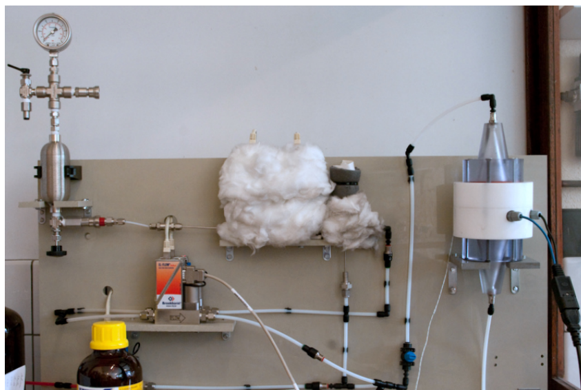
FIGURE 2.40 – Montage final de l'unité pilote d'adsorption–désorption en dynamique.
