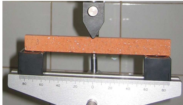
FIG. 2.12 – Essai de flexion "trois points" dont la charge est appliquée selon la hauteur de l'éprouvette.
