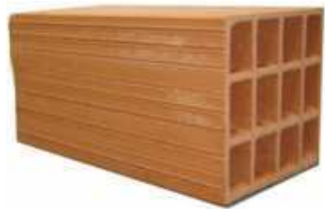
FIG. 2.5 – Brique utilisée pour l'essai de détermination de l'évolution de \lambda .
