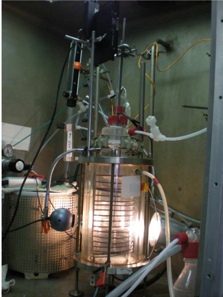
Figure A-11. Photographie du montage expérimental dédié aux études sur gouttes (LI1, Atalante, Marcoule)
