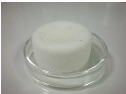
Figure A-1. Photographie d'un bloc de LiF-CaF<sub>2</sub> obtenu après purification
