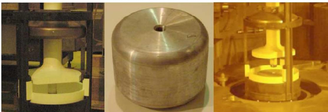
**Figure II-6. Prototype de cathode liquide de cadmium développé à l'ANL**
