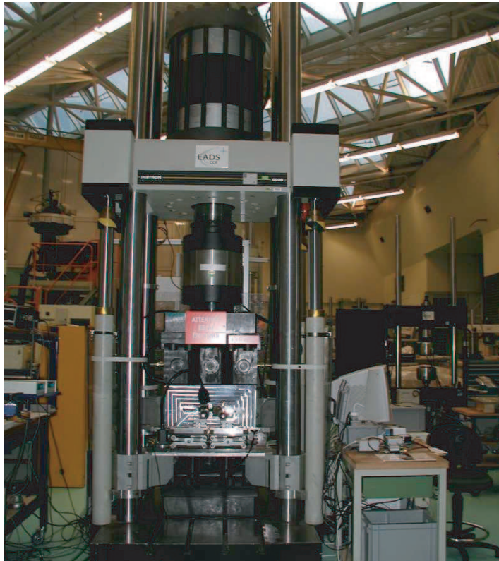
FIGURE 3.1 : Machine d'essai employée pour l'essai de traction sur le matériau composite.
