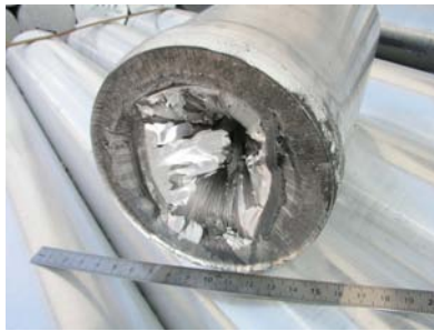
FIGURE 3.4 – Défaut d'invagination sur un profilé d'aluminium.
