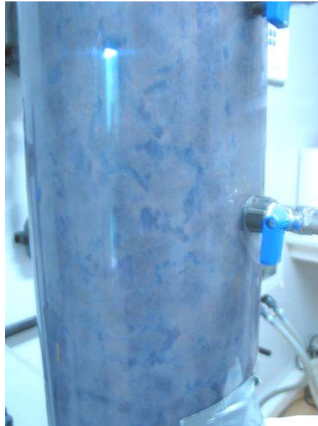
Figure 54 : Chenalisation du milieu en présence du biofilm (essai à 40 \text{ L.h}^{-1} )
