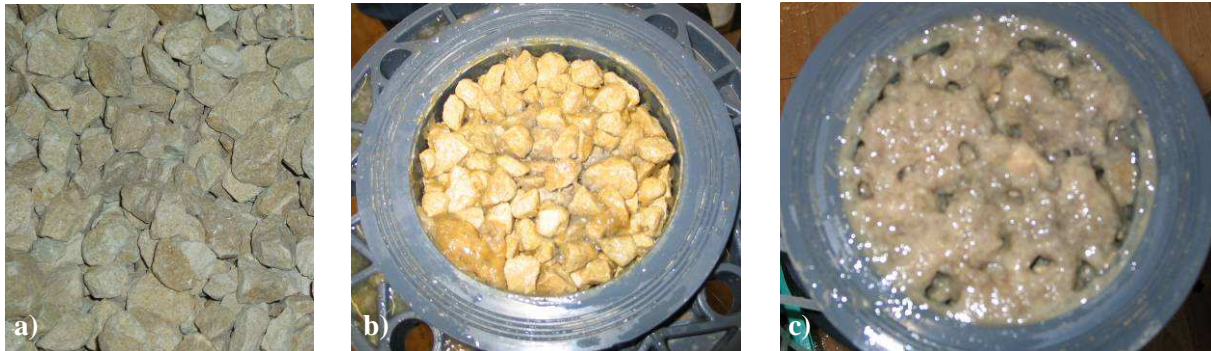
Figure 40 : Différents états de colonisation du milieu par le biofilm. a) milieu initial, absence de biofilm, b) milieuensemencé, essai E à 30,1 L/h, c) milieuensemencé, essai F à 40,8 L/h
