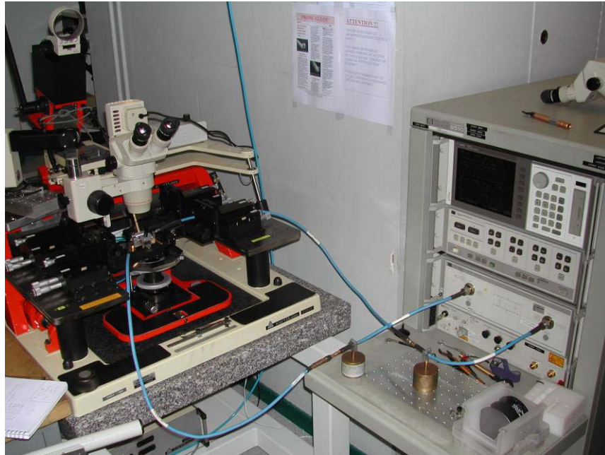
Figure IV.9 : Photographie du banc de test opto-microonde permettant l'analyse du contrôle optique de composants hyperfréquences en technologie coplanaire
