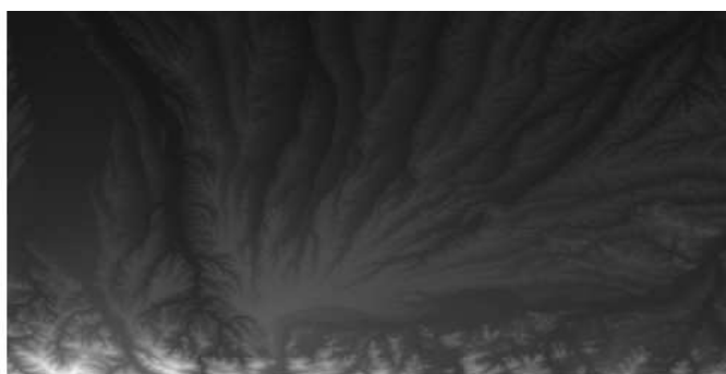
Fig. 1.7 – Exemple de DTED - Les pixels noirs représentent les points de basse altitude et les pixels blancs les points de haute altitude.
