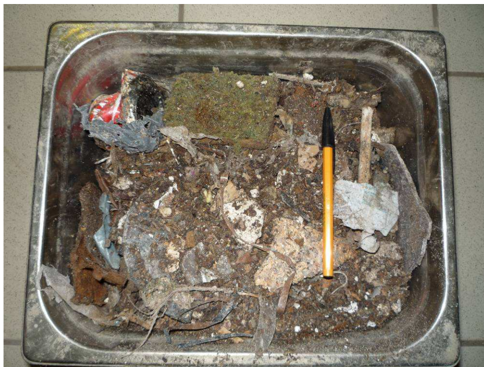
Figure Annexe 6 : Déchet D (DIB broyé à 150 mm), utilisé notamment dans l'essai C3.1
