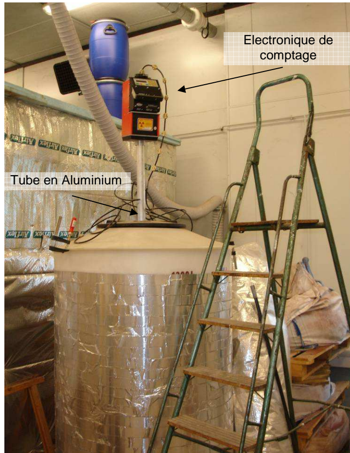
Figure III-21 : photographie de la sonde neutrons au LGCIE (INSA de Lyon) en train de mesurer le comptage standard dans une cuve remplie d'eau.
