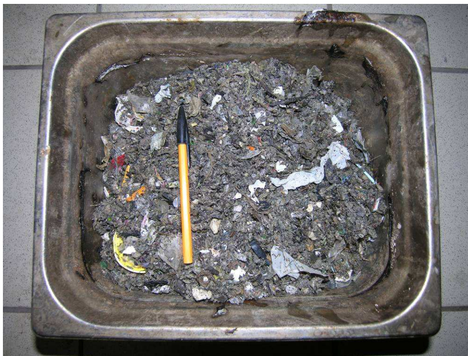
Figure Annexe 8 : Déchet E (OM broyée à 40 mm), utilisé notamment dans l'essai C1.2.
