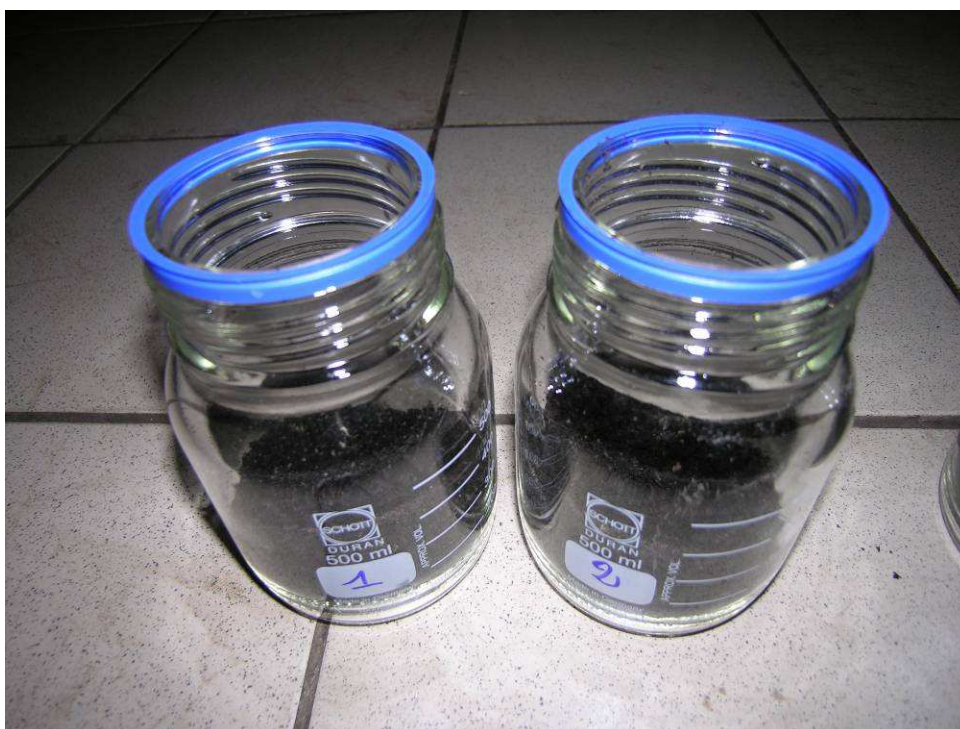
Figure III-3 : photographie des flacons remplis de déchets – ici la fraction fine du déchet C.
