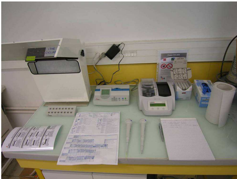
Figure IV-4 : photographie des dispositifs d'analyse chimique des lixiviats (hotte, micro-pipettes, analyseur spectrométrique LASA 100 et thermostat de chauffage des tubes à essai LT 200).
