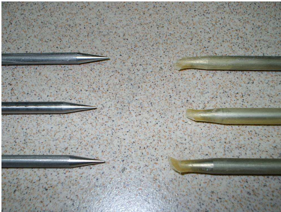
Figure III-11 : photographie de l'extrémité de sondes TDR. À gauche, une sonde non gainée, à droite, une sonde gainée.
