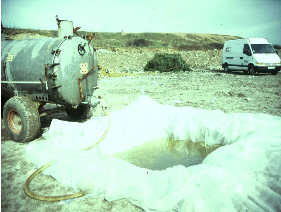
Figure III-1 : mesure de la masse volumique in situ par remplissage d'une bâche imperméable (Thomas, 2000).
