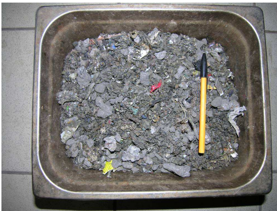
Figure Annexe 9 : Déchet F (OM broyée à 40 mm avec ajout de mâchefers), utilisé notamment dans l'essai C2.2. A noter que, pour la photo, une sur-représentation des mâchefers en surface du déchet a été réalisée, afin de mieux différencier ce déchet du déchet E.
