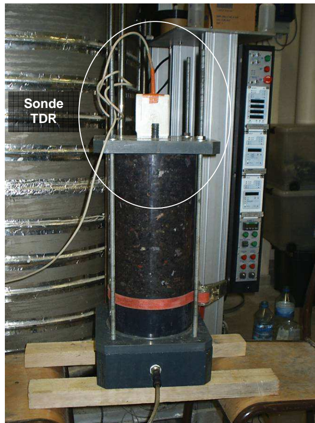
Figure II-20 : photographie de la cellule Alpha utilisée ici pour calibrer une sonde TDR.
