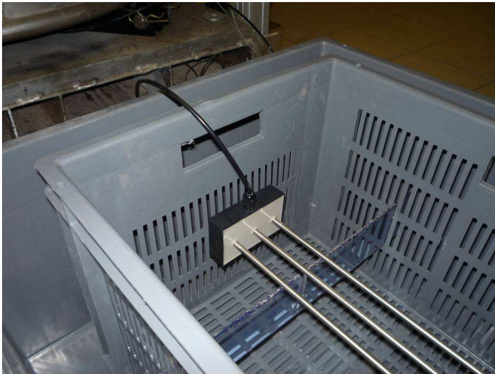
Figure III-14 : expérience de détermination du volume de mesure des sondes TDR. Ici, une sonde LTHE avant le chargement du déchet en position horizontale.
