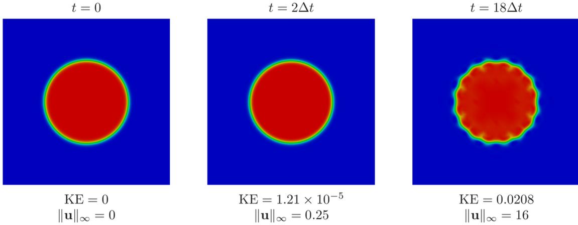
FIG. VII.2 – Paramètre d'ordre  $c$ , Energie cinétique (KE) et norme infinie de la vitesse sur le domaine.
