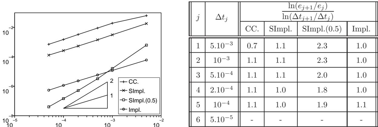
FIG. V.10 – Erreurs  $e_j(t) = |\mathbf{c}^{\Delta t_j}(t, \cdot) - \mathbf{c}^{\Delta t_{\text{ref}}}(t, \cdot)|_{(L^2(\Omega))_3}$  au temps  $t = 1.5$  en fonction du pas de temps  $\Delta t_j$  (à gauche) et ordres de convergence (à droite) obtenus avec les différents schémas.
