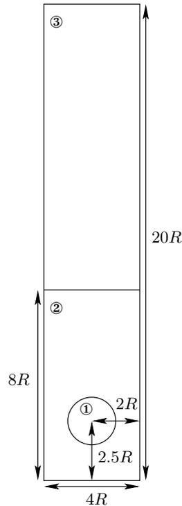
FIG. IX.1 – Configuration initiale du cas test
