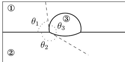
FIG. IV.4 – Définition des angles de contact
