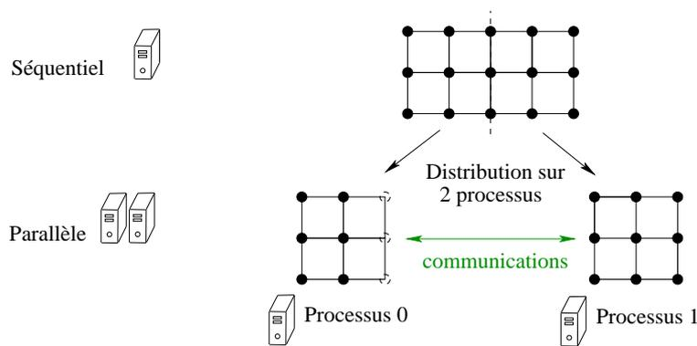
FIG. III.4 – Techniques de calcul parallèle – Partitionnement du domaine
