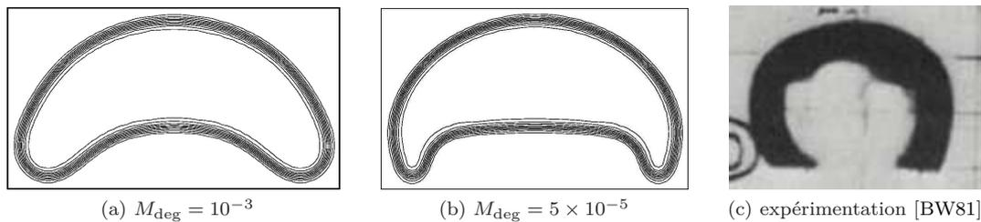
FIG. VIII.11 – Comparaison des simulations cas (h) aux expérimentations de [BW81] ( $Bo = 339$ ,  $Mo = 43.1$ ,  $Re = 18.3$ ,  $\frac{\rho_1}{\rho_2} = 1050$ ,  $\frac{\eta_1}{\eta_2} \geq 4 \times 10^3$ )
