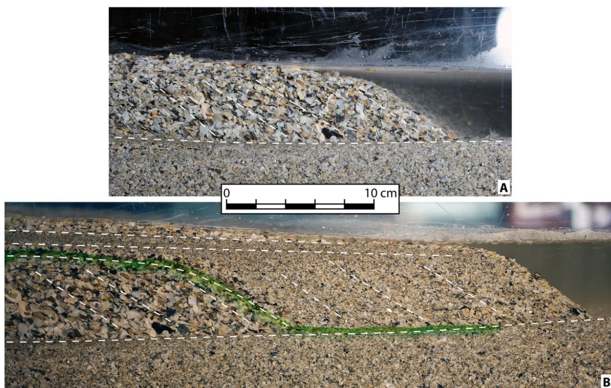
FIG. V.16 – Formation et évolution d'un delta de washover. Les premiers dépôts sont très grossier, le matériel provenant des laisses de haut niveau démantelées (A). Lorsque la distance entre la crête de banc et la dépression d'arrière cordon devient grande (du fait de la progradation des deltas), l'écoulement perd de sa compétence, et dépose une partie du sédiment au-dessus du niveau de submersion, en litages sub-parallèles à faible pendage vers la terre (B). On parle de nappes de washover. La progradation des deltas peut être très rapide. Seulement quelques minutes séparent les deux clichés (A et B).
