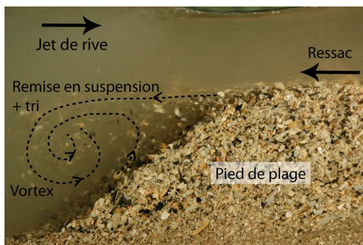
FIG. V.9 – Mise en suspension et tri du sédiment dans la zone de déferlement. La rencontre du déferlement gonflant et du ressac crée un vortex fortement érosif, qui creuse le pied de banc.
