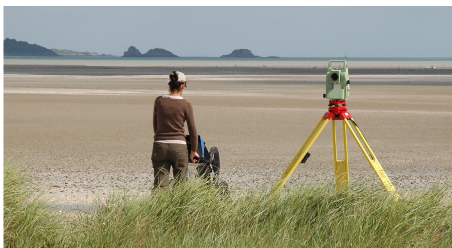
FIG. III.6 – Station totale Leica TPS410C utilisée pour les relevés topographiques des profils radar.
