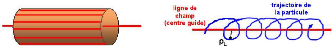
Figure 1-4 : A gauche, lignes de champ magnétique dans une configuration linéaire. A droite, trajectoire d'une particule chargée autour d'une ligne de champ magnétique.
