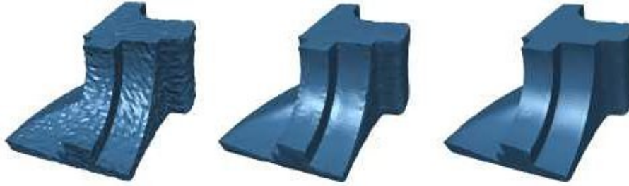
FIG. 4.3 : Exemple de débruitage de surface par une analyse fréquentielle du maillage (images issues de [Flei 03]), le bruit est essentiellement décrit par les hautes fréquences du spectre.
