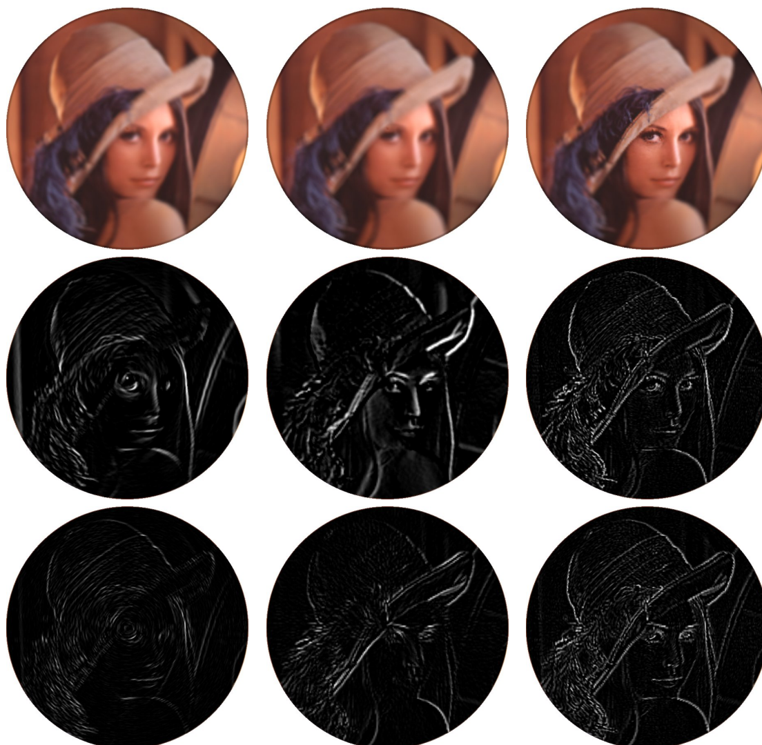
FIG. 3.33 : Différents filtres polaires, de gauche à droite : trois filtrages gaussiens de variance 4, 8 et de variance croissante selon le rayon du disque (taille 20 \times 20 ). Sur la deuxième ligne, filtres gradient radial, angulaire puis omnidirectionnel de taille 3 \times 3 . Sur la troisième, filtres laplacien radial, angulaire puis omnidirectionnel de taille 3 \times 3 .
