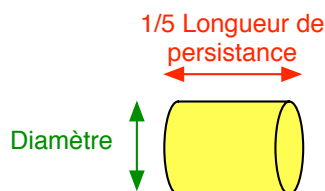
FIG. 3.7 – Cylindre de base du modèle 3D
