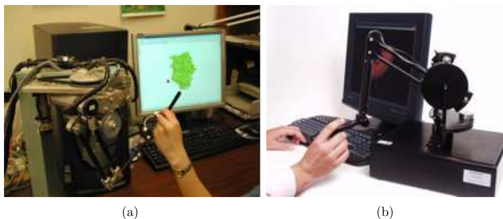
FIG. 1.19 – (a) Interface utilisateur avec le dispositif haptique de CAMD (b) Le dispositif haptique PHANTOM pour l'application HAMStER
