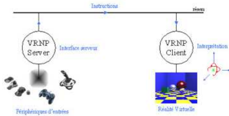
FIG. B.10 – Schéma de principe du dispositif VRPN Server et Client
