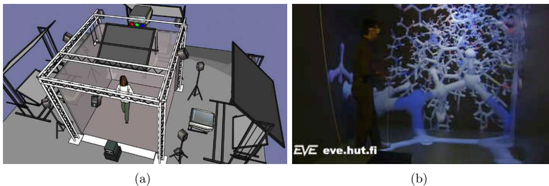
FIG. 1.2 – La plateforme EVE de l’université de technologie de Helsinki : (a) le dispositif matériel (par Seppo Ayravainen) et (b) une application d’exploration de molécule ( http://eve.hut.fi/ )
