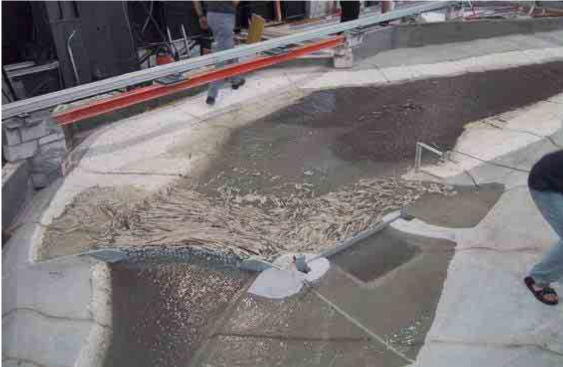
Photographie 15 : Tests en modèle réduit du piège à flottants installé sur la Gürbe (Suisse, G.R. Bezzola).
