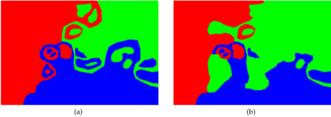
FIGURE 6.14 – (a) Etiquetage des pixels d'une image avec trois étiquettes (rouge, verte et bleue). (b) Etiquetage des pixels après une opération de verte-expansion.
