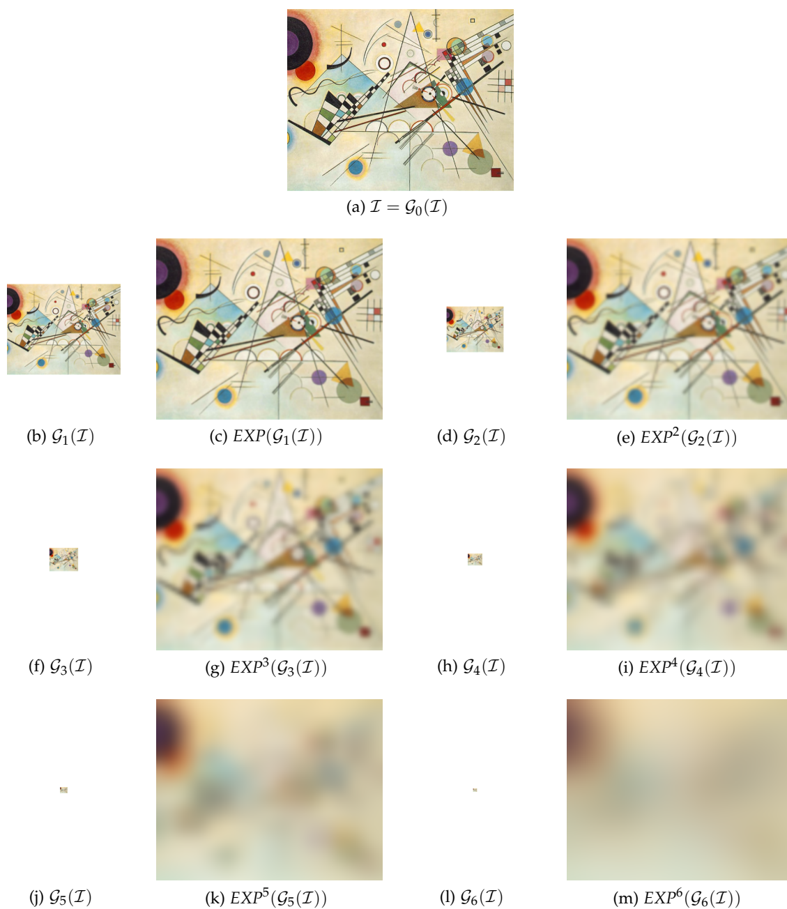
FIGURE 8.10 – Pyramide gaussienne de 7 niveaux d'une image 2D.
