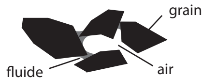
FIGURE 3.3: Schématisation, à l'échelle du grain, d'une roche non saturée
