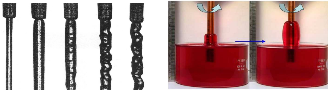
FIGURE 1.24 – Deux manifestations de la présence des contraintes normales dans les fluides visco-élastiques. À gauche : photographie d'un jet d'une solution de polymères à la sortie d'un canal. La pression augmente en allant vers la droite. Des irrégularités apparaissent dans le jet précédant la fracture [71, 72]. Issue de http://www.ilorentz.org/saarloos/Patternf/meltfracture.html . À droite : l'effet Weissenberg fait grimper le fluide le long de l'axe tournant ( http://web.mit.edu/nmf/research/phenomena/rodclimbing.html ).
