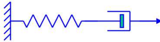
FIGURE 1.4 – Représentation schématique du modèle de Maxwell : association en série d'un ressort (le solide, de module élastique G_0 ) et d'un amortisseur visqueux (le fluide, de viscosité \eta_0 ).
