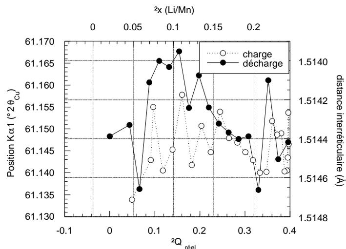
figure III.47: évolution de la position de la réflexion 224 de  $Li_2Mn_2O_4$  au cours du cyclage (écart type  $\pm 0.008^\circ$ ).
