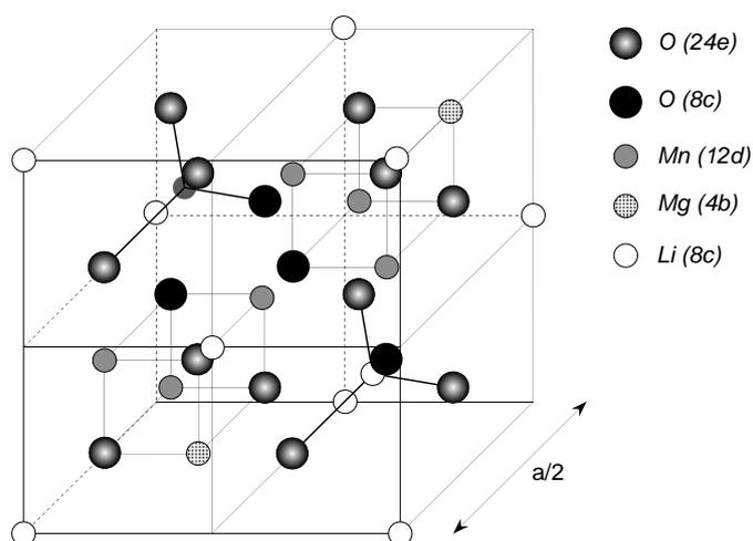
figure IV.17: structure d'une demi-maille de LiMg<sub>0.5</sub>Mn<sub>1.5</sub>O<sub>4</sub> schématisée de manière à rendre évidentes les correspondances avec la maille spinelle  $Fd3m$ .
