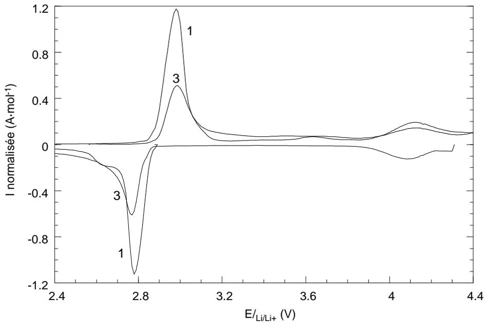
figure IV.22: voltampérométrie de  $\text{LiAl}_{\epsilon}\text{Mn}_{2-\epsilon}\text{O}_4$  en électrolyte liquide, incluant une étape à 4V (EL39, 25°C,  $m = 78.39 \text{ mg}$ ,  $10 \text{ mV} \cdot \text{h}^{-1}$ ). Le numéro du cycle est indiqué.
