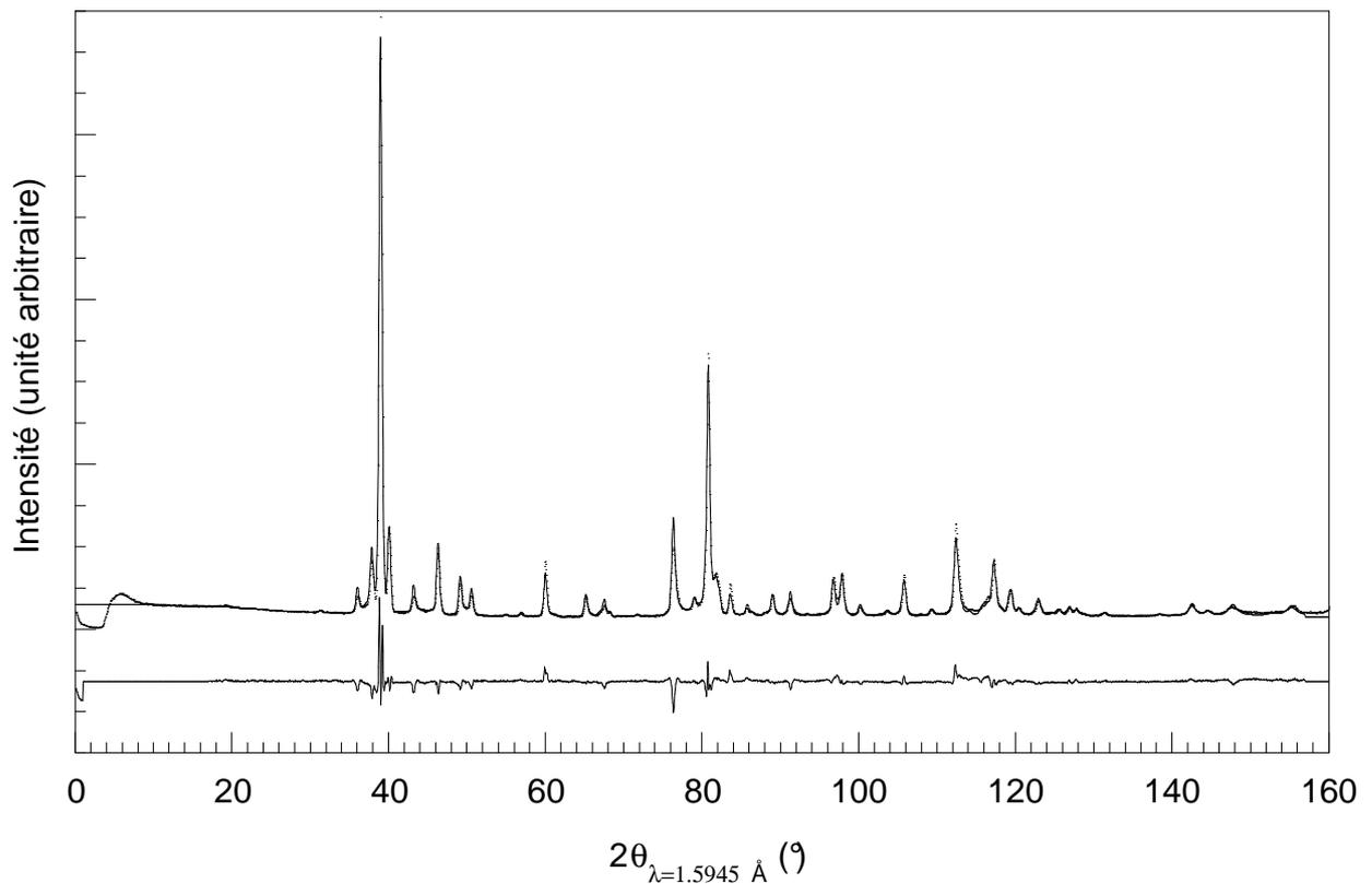
figure IV.3: résultat de l'affinement du diffractogramme neutronique de l'échantillon 925Q.
