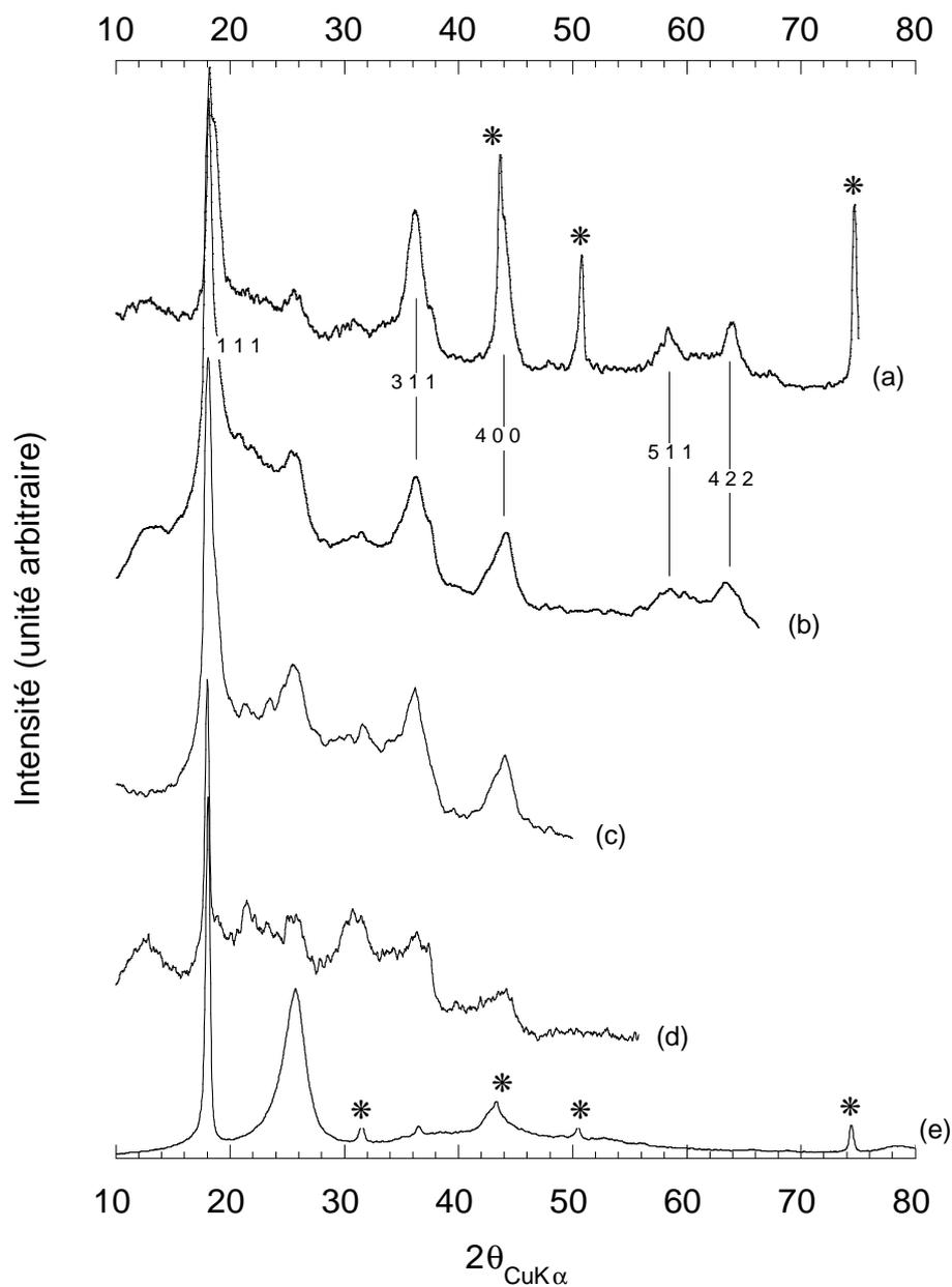
figure II.32: diffractogrammes RX réalisés sur électrodes positives après cyclage.
