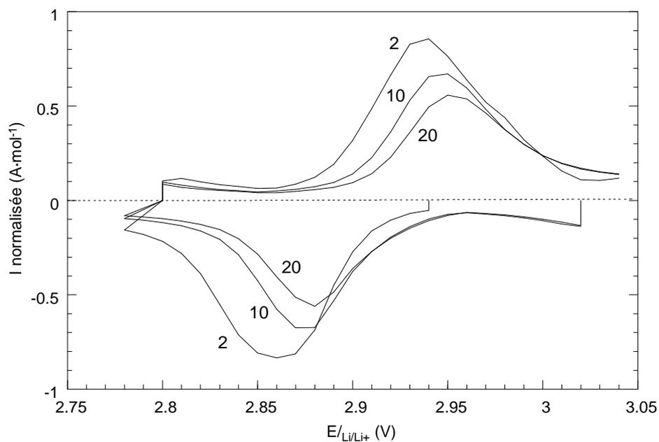
figure IV.19: voltampérométrie de " $\text{LiAlMnO}_4$ " en électrolyte polymère ( $110^\circ\text{C}$ ,  $m = 607\text{mg}$ , vitesse de balayage:  $10\text{ mV}\cdot\text{h}^{-1}$ ). Le numéro du cycle est indiqué.
