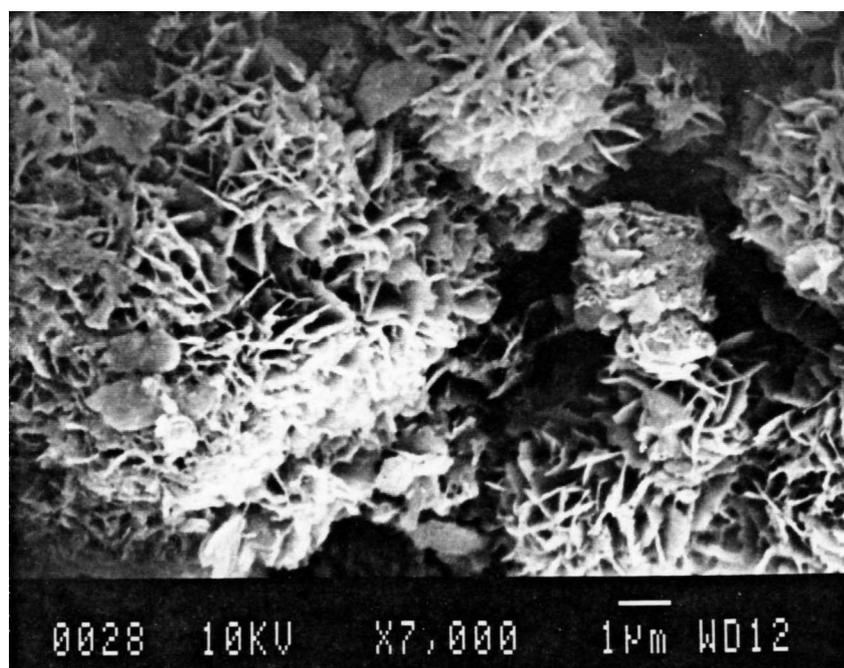
figure II.17: photographies au MEB des échantillons 17 (phyllosilicate de sodium) et 17d (phyllosilicate de lithium).
