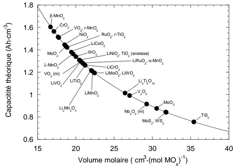
Figure I-3: évaluation de la capacité volumique théorique relative à l'insertion d'un  $\text{Li}^+$  par formule  $\text{MO}_x$  dans différents composés <sup>15</sup>.
