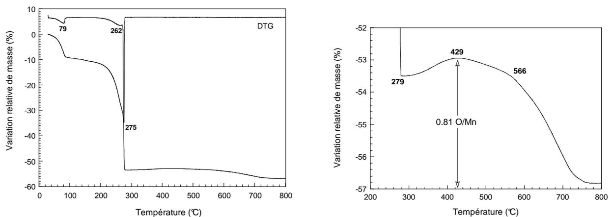
figure IV.12 : thermogravimétrie du mélange de carbonates Li-Mn et d'acétate d'aluminium sous oxygène à  $60^{\circ} \text{h}^{-1}$  à droite: agrandissement)
