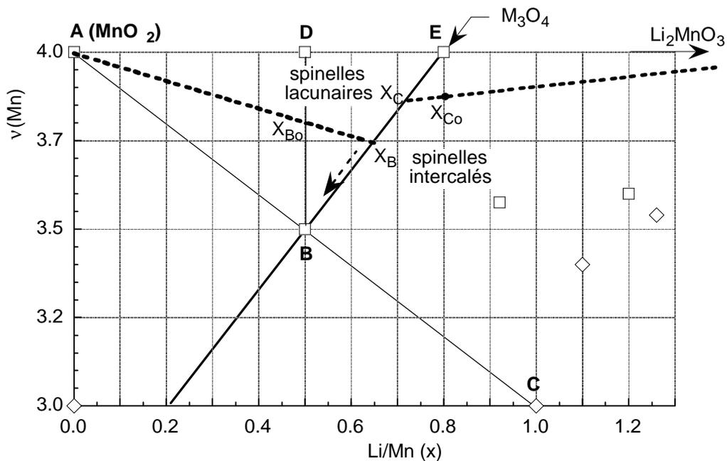
figure III.7: diagramme composition-valence montrant la variation de composition de la phase spinelle en présence d'un excès de  $\text{MnO}_2$  (ligne A- $X_B$ ) ou d'un excès de  $\text{Li}_2\text{MnO}_3$  (ligne  $\text{Li}_2\text{MnO}_3$ - $X_C$ ).
