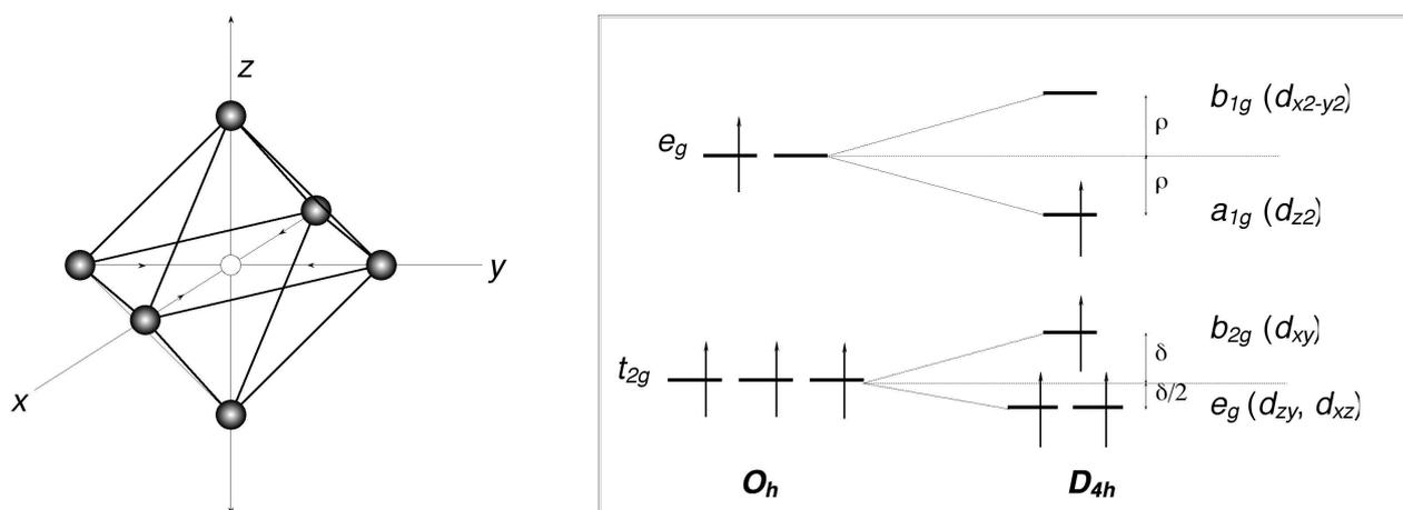
Figure I-14: illustration schématique de la déformation Jahn-Teller d'un octaèdre  $MnO_6$ , montrant la stabilisation de l'ion  $Mn^{3+}$  par une baisse de symétrie ( $O_h \rightarrow D_{4h}$ ).<sup>27</sup>
