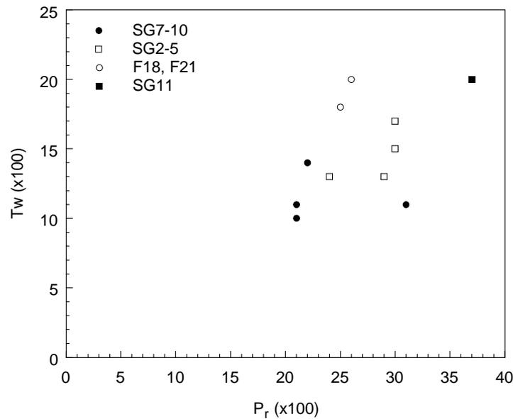
Figure II-5: localisation dans l'espace (taux de défauts  $\beta$ - $MnO_2$ , taux de micromaclage) d'échantillons de ramsdellite synthétique, classés par famille de composés initiaux. F18, F21 ( $LiMn_2O_4$  700°C), SG2-6 ( $LiMn_2O_4$  850°C), SG7-10 ( $\lambda$ - $MnO_2$ ), SG11 ( $Li_{1.29}Mn_{1.71}O_4$  400°C).
