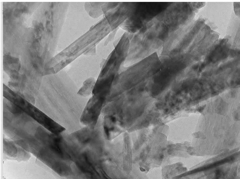
figure II.7: photographie MET de cristaux colonnaires de  $\gamma\text{-MnO}_2$  (F18).
