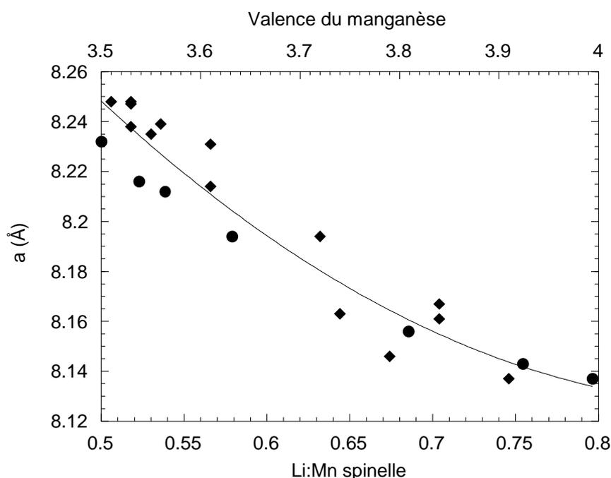
figure III.1: évolution du paramètre de maille le long de la solution solide  $\text{Li}_{1+\delta}\text{Mn}_{2-\delta}\text{O}_4$  (♦ Masquelier<sup>13</sup>, ● Gummow<sup>16</sup>, trait plein: interpolation parabolique).
