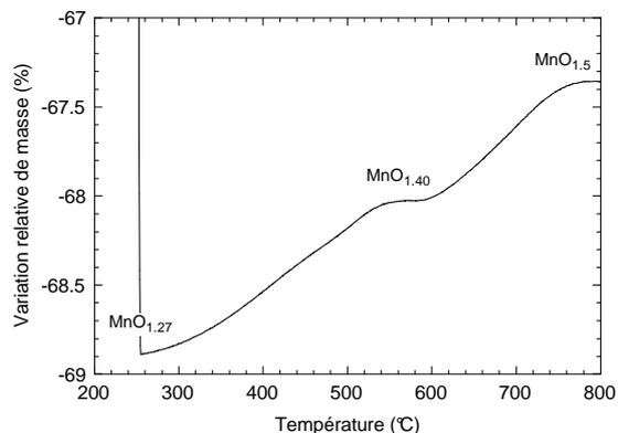
figures III.7a,b : thermogramme de  $Mn(CH_3COO)_2 \cdot 4H_2O$  sous oxygène à  $1^\circ C \cdot min^{-1}$ .
