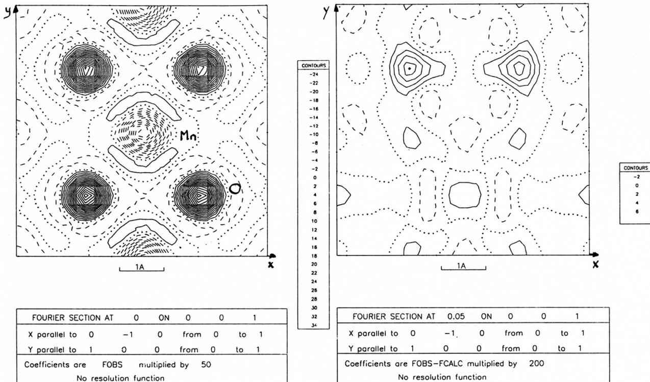
figure IV.4a,b. (a) section de Fourier à  $z = 0$  et (b) de Fourier différence déterminée à partir du modèle de déplacement isotrope de l'oxygène à  $z = 0.05$  mettant en évidence une densité électronique résiduelle importante au voisinage des atomes d'oxygène le long de l'axe  $z$ .
