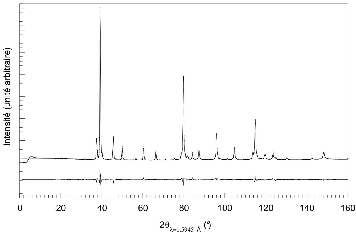
figure IV.1 (haut) et IV.2 (bas): résultat de l'affinement du diffractogramme neutronique des échantillons 800SC et 800Q
