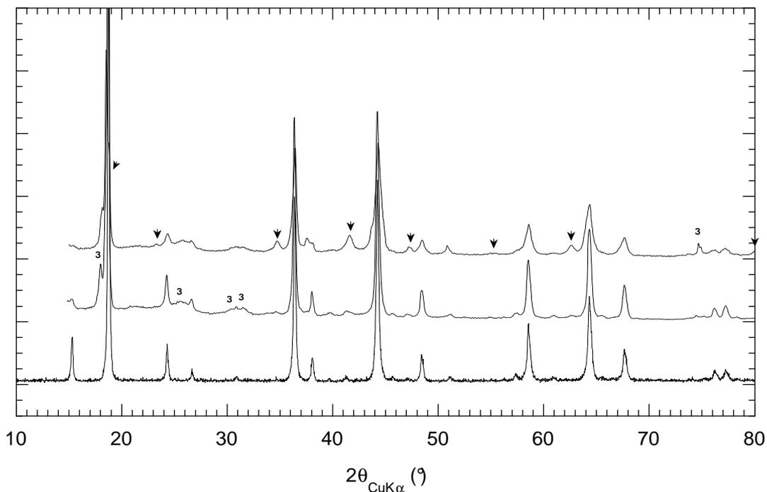
figure IV.24: évolution du diffractogramme RX de  $\text{LiMg}_{0.5}\text{Mn}_{1.5}\text{O}_4$  avec l'insertion de lithium: (a) composé initial, (b) cellule EL111: réduction jusqu'à 2.4 V (insertion de 0.54  $\text{Li}^+$ /formule), (c) cellule EL112: réduction jusqu'à 1.9 V (insertion de 0.82  $\text{Li}^+$ /formule). ↓ phase quadratique, ◇ contribution du mélange cathodique.
