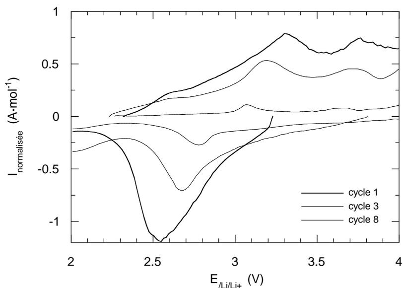
Figures II.30: évolution des voltampérogrammes à  $10 \text{ mV}\cdot\text{h}^{-1}$  des phyllosulfates de sodium (en haut) et de lithium (en bas) au cours des cycles charge-décharge
