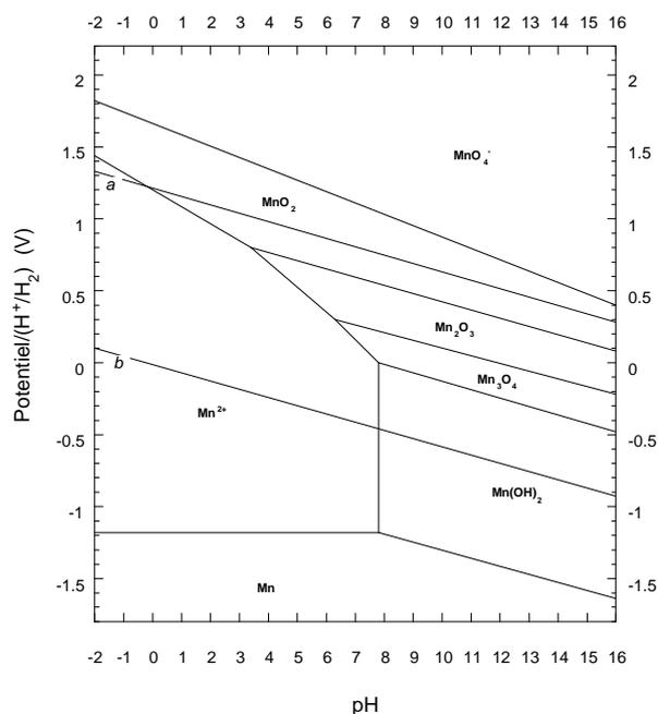
figure II.14: diagramme d'équilibre tension-pH du manganèse en solution aqueuse à 25°C (activité = 1).<sup>59</sup>
