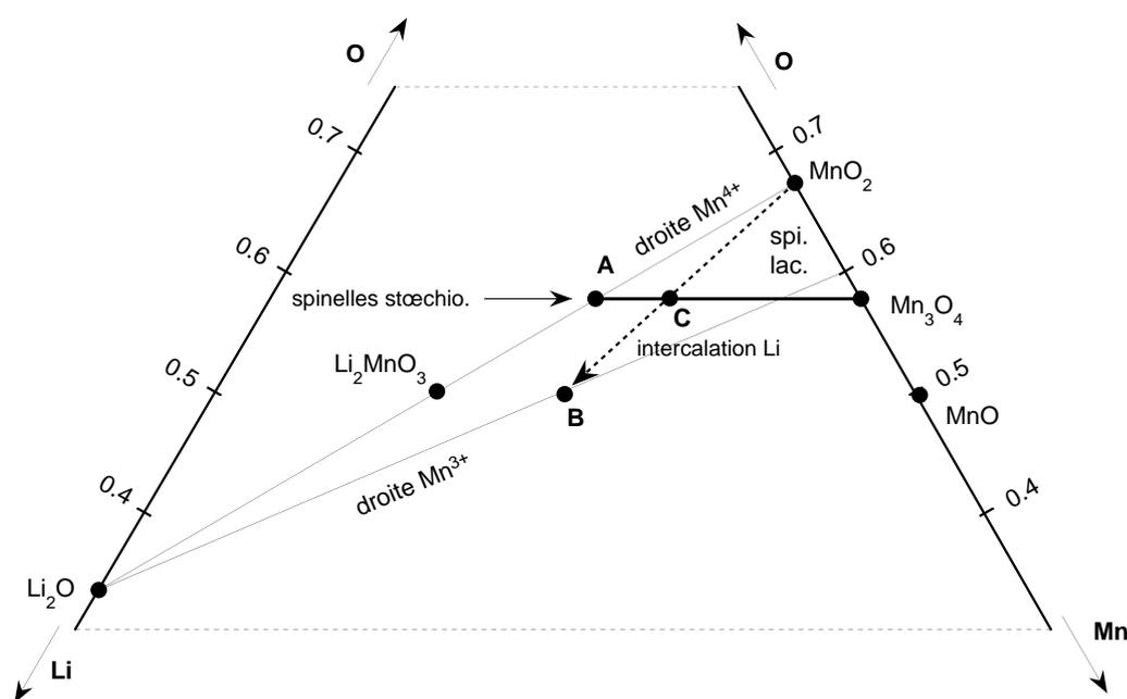
figure III.4: portion du diagramme de phase triangulaire Li-Mn-O.
