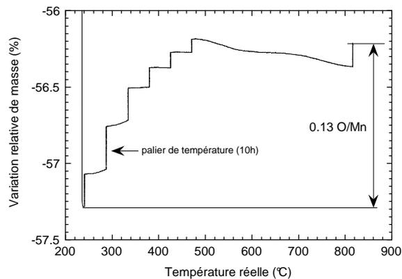
oxyde où  $\nu_0(\text{Mn}) \approx 2.54$  (figure III.7a,b). La poursuite de la montée en température mène ensuite à une conversion complète en  $\text{Mn}_2\text{O}_3$ .
