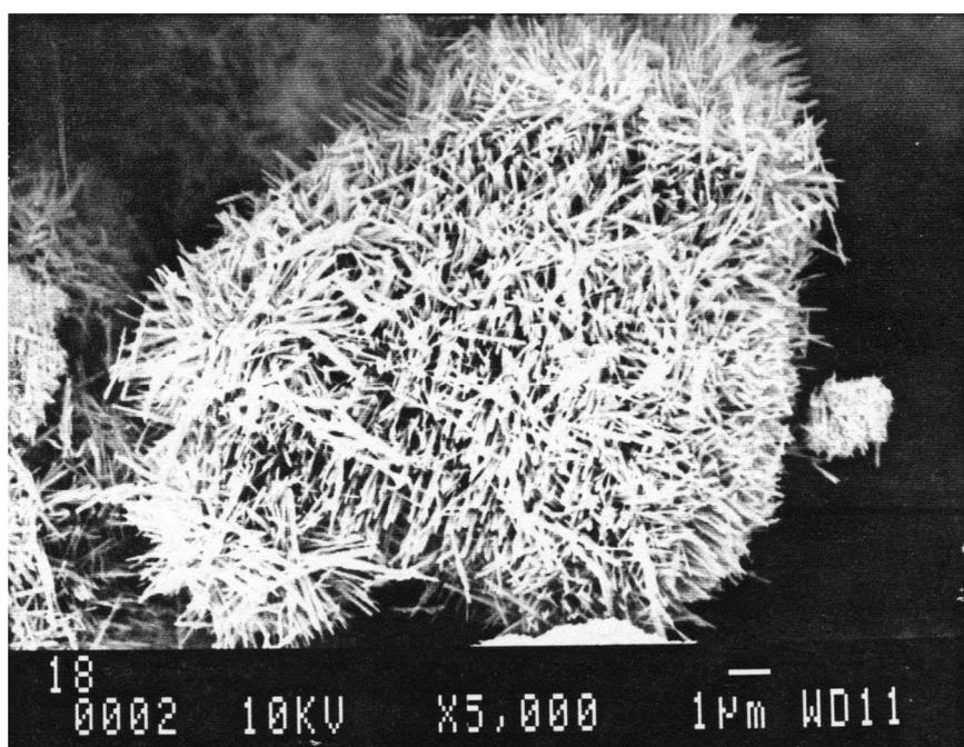
figures II.6a,b,c: photographies MEB des échantillons F15c, F15d, F18 montrant la morphologie des grains à respectivement 1h30, 6h et 24h de traitement acide.
