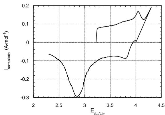
figure II.28: premier cycle ayant débuté par une charge du phyllomanganate de sodium ( $v_b = 10\text{mV}\cdot\text{h}^{-1}$ ).
