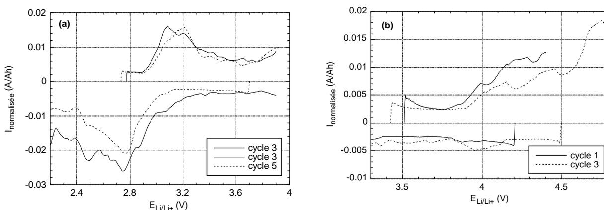
figure IV.32. voltampérométrie de la phase m en électrolyte liquide (EL125, 25°C,  $m = 19.60$  mg, vitesse de balayage:  $12.5 \text{ mV} \cdot \text{h}^{-1}$ ). Domaines de potentiel: (a) 2.2–3.9 V, (b) 3.3–4.8 V.
