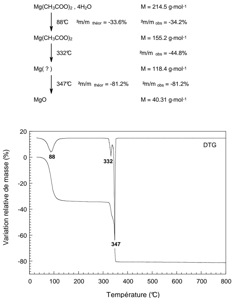
figure IV.10. analyse thermogravimétrique de l'acétate de magnésium
