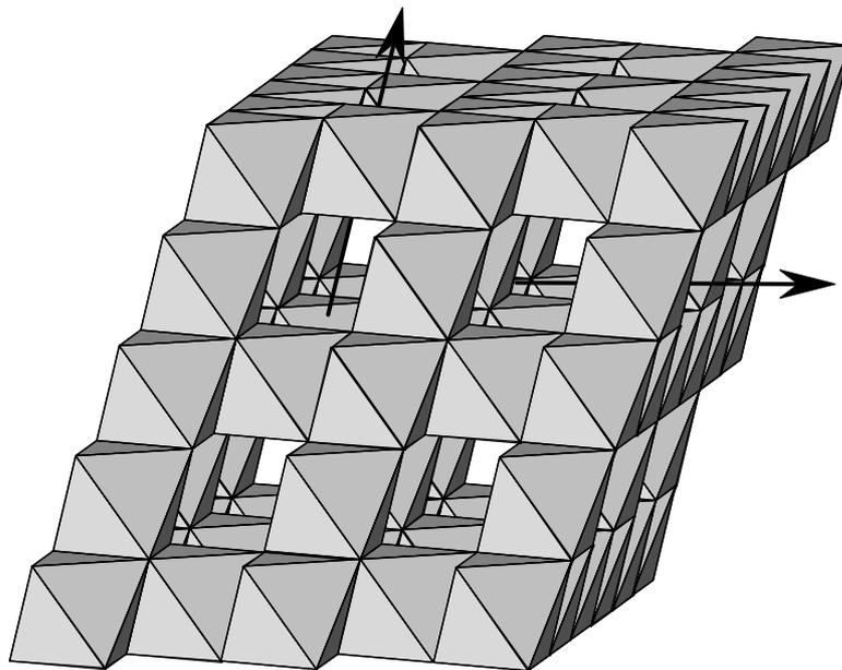
Figure I-12: empilement des octaèdres  $[MnO_6]$  dans la structure spinelle, correspondant à la structure idéalisée de  $\lambda$ - $MnO_2$
