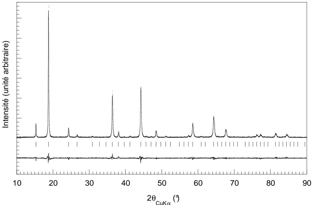
figure IV.16: diffractogrammes RX expérimental et calculé par affinement de structure de  $\text{LiMg}_{0.5}\text{Mn}_{1.5}\text{O}_4$  traité à 700°C (méthode de Rietveld).
