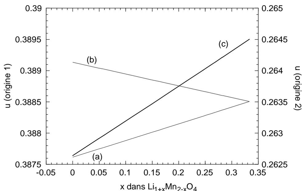
figure IV.6: évolution du paramètre  $u$  des spinelles Li-Mn-O cubiques et stœchiométriques: (a) distances O-M théoriques avec  $\text{Mn}^{3+}$  haut spin, (b) distances O-M théoriques avec  $\text{Mn}^{3+}$  bas spin, (c) distances O-M affinées.
