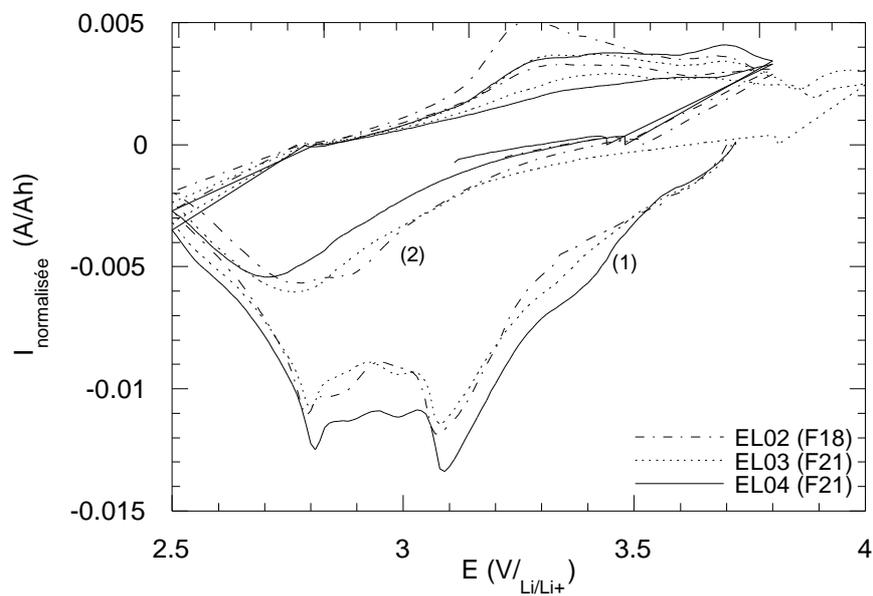
figure II.11: voltampérogrammes de "ramsdellite" synthétique en électrolyte liquide à  $v_b=10 \text{ mV}\cdot\text{h}^{-1}$ .
