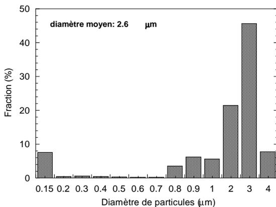
figure III.16: granulométrie du  $\beta\text{-MnO}_2$  broyé par dispositif à jet d'air.
