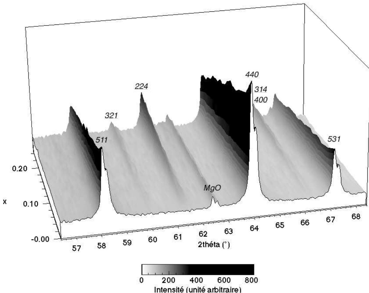
figure III.39: évolution du diffractogramme de l'électrode positive au cours de la décharge ( $x$  correspondant à la composition  $\text{Li}_{1+x}\text{Mn}_2\text{O}_4$ ). Indices non soulignés,  $\text{LiMn}_2\text{O}_4$ , indices soulignés  $\text{Li}_2\text{Mn}_2\text{O}_4$ .
