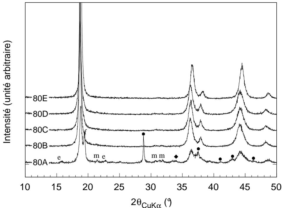
figure III.18: diffractogrammes RX sur l'échantillon C80 ( $x_0 = 0.65$ ) à différentes étapes du traitement thermique: de bas en haut: 5h (A), 10h (B), 15h (C), 20h (D) à  $250^\circ\text{C}$ , + 5h à  $400^\circ\text{C}$  (E). Impuretés: mêmes symboles que figure III.17.
