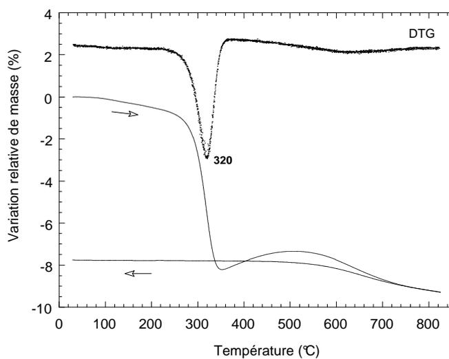
figure III.24: thermogramme sous 1 atm d'oxygène d'un mélange à  $x_0=0.8$  ayant réagi préalablement 5 semaines à  $150^\circ\text{C}$ . Montée  $0.2^\circ\text{C}\cdot\text{min}^{-1}$ , descente  $1^\circ\text{C}\cdot\text{min}^{-1}$ .
