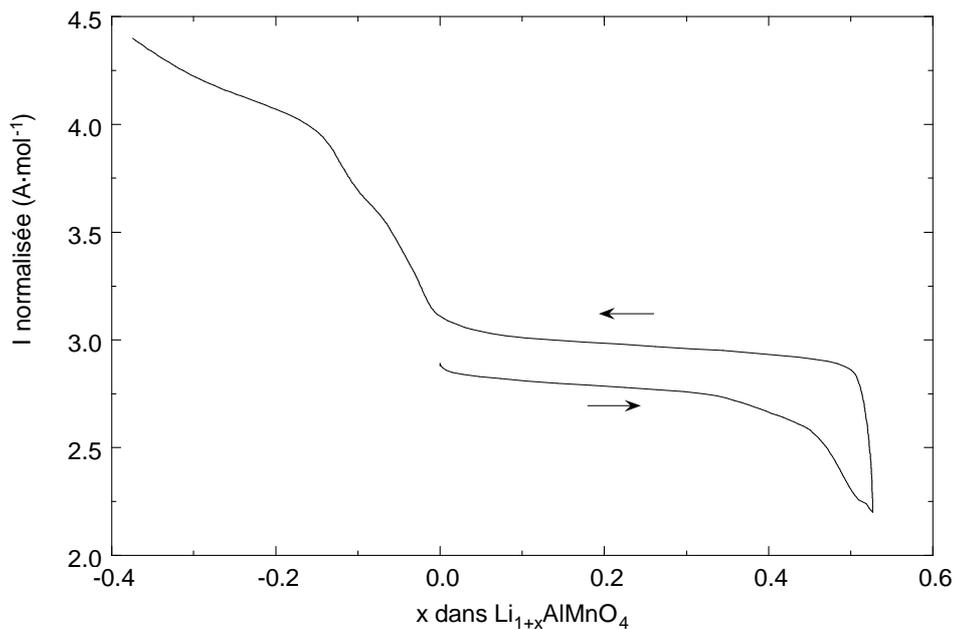
figure IV.23: évolution du potentiel en fonction du taux d'insertion de lithium dans  $\text{LiAl}_{\epsilon}\text{Mn}_{2-\epsilon}\text{O}_4$  (EL39, 25°C,  $m = 78.39 \text{ mg}$ , vitesse de balayage:  $10 \text{ mV} \cdot \text{h}^{-1}$ ).
