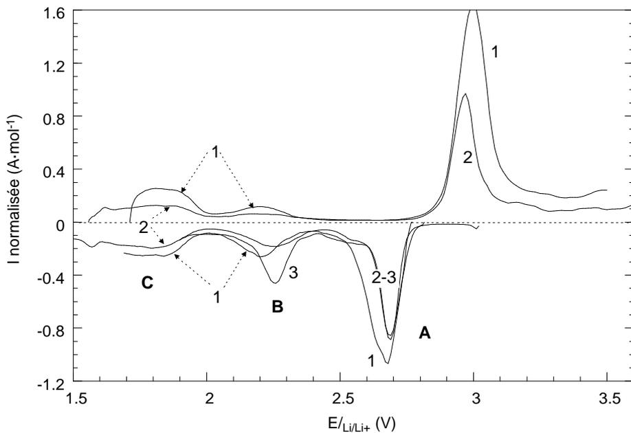
figure IV.20: voltampérogramme de  $\text{LiMg}_{0.5}\text{Mn}_{1.5}\text{O}_4$  en électrolyte liquide (25°C,  $m = 34.64$  mg, vitesse de balayage:  $10 \text{ mV}\cdot\text{h}^{-1}$ ). Le numéro du cycle est indiqué.
