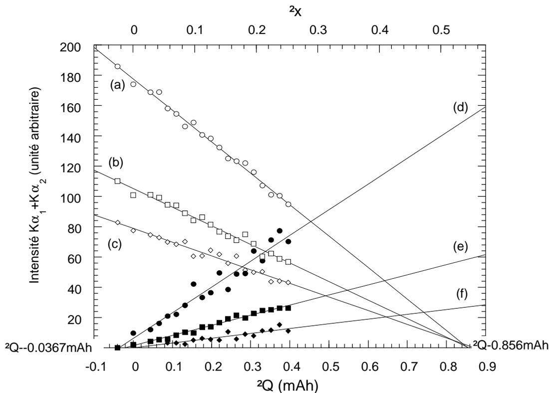
figure III.40: évolution des intensités intégrées des réflexions de  $LiMn_2O_4$ : au cours de la décharge. (a) 440, (b) 511, (c) 531 et de  $Li_2Mn_2O_4$ : (d) 224, (e) 400-314, (f) 321. Les droites représentent des extrapolations linéaires.
