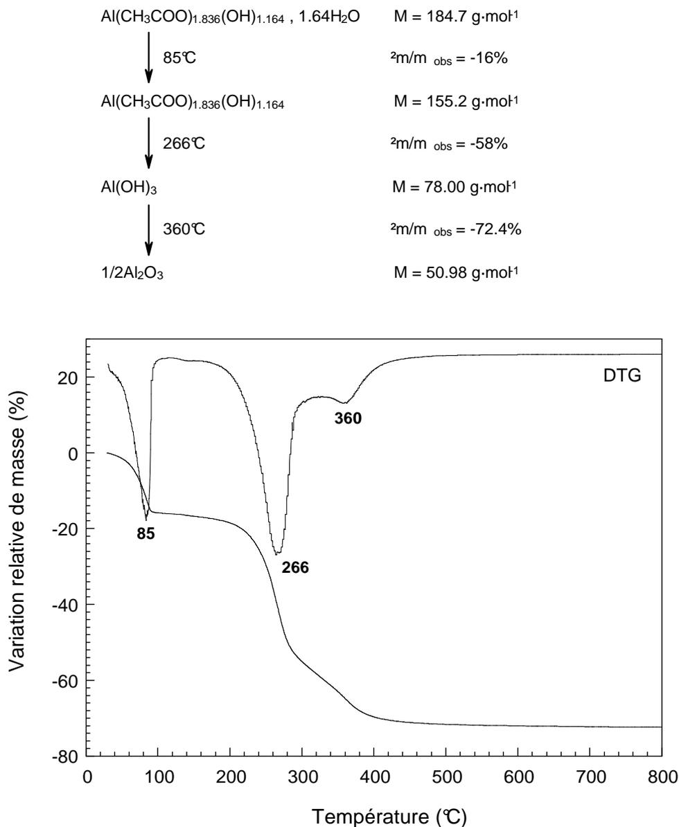
figure IV.9. analyse thermogravimétrique de l'acétate basique d'aluminium
