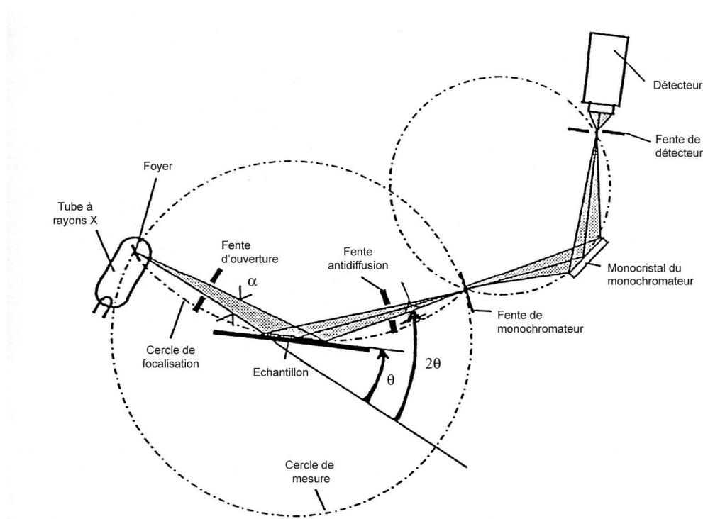
Figure I-17: schéma de la configuration optique du diffractomètre Siemens D5000 (Bragg-Brentano).
