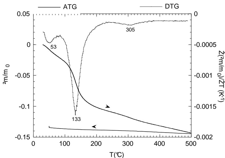
figure II.23 : thermogramme du phyllomanganate de lithium S11 sous oxygène (montée à 1°C·min<sup>-1</sup>, palier de 30 minutes à 500°C, descente à 10°C·min<sup>-1</sup>).
