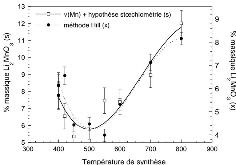
figure III.19: comparaison des fractions résiduelles de  $\text{Li}_2\text{MnO}_3$  (1) estimées dans l'hypothèse d'un spinelle stœchiométrique, (2) déduites d'un affinement de structure.  $x_0 = 0.8$ . (lignes continue et pointillée: lissage par un polynôme de degré 3).
