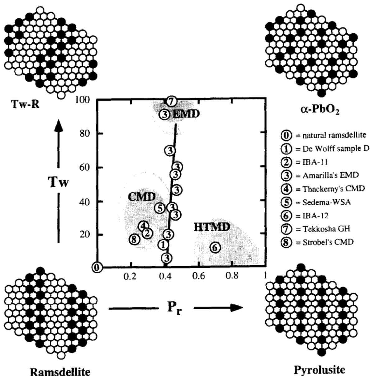
figure II-2: diagramme structural de  $\gamma\text{-MnO}_2$  représentant plusieurs variétés de  $\gamma\text{-MnO}_2$ . CMD: "chemical manganese dioxide", EMD: "electrochemical manganese dioxide", HTMD: "heat treated manganese dioxide". (d'après 5).
