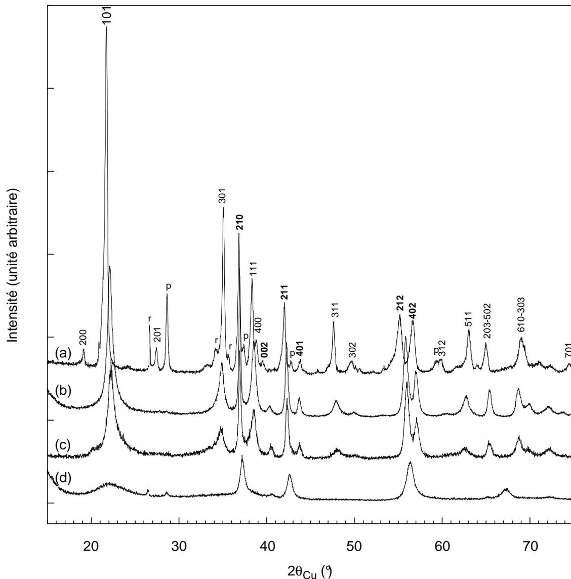
Figure II-3: diffractogrammes RX de : (a) ramsdellite naturelle, (b) échantillon F18 (b), (c-d) autres  $\gamma\text{MnO}_2$  synthétiques [IBA11 (c), Tekkosha GH (d)]. Les réflexions indiquées en gras (maille  $Pnma$ ) servent de référence pour le calcul des taux de défauts. p:  $\beta\text{-MnO}_2$ , r: composé réduit proche de la manganite ( $\text{MnOOH}$ ).
