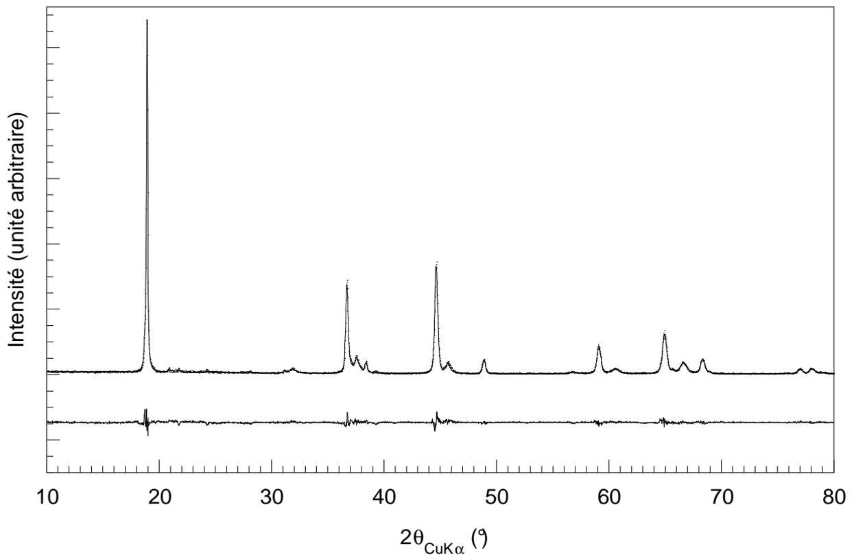
figure IV.15b: diffractogrammes RX expérimental et calculé par affinement de structure de  $\text{LiAl}_\varepsilon\text{Mn}_{2-\varepsilon}\text{O}_4$  traité à  $700^\circ\text{C}$  (méthode de Rietveld).
