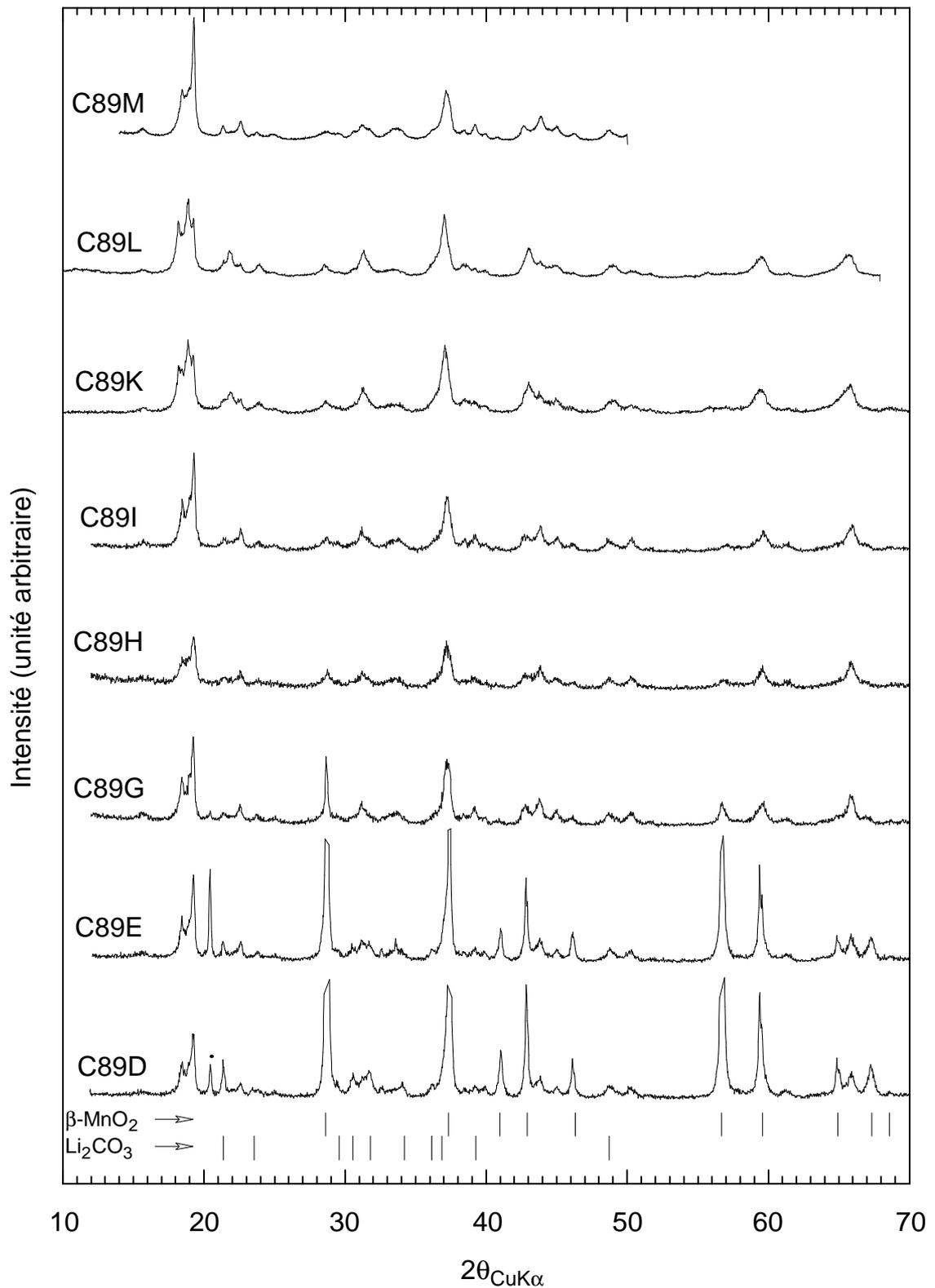
figure IV.26: diffractogrammes RX du mélange C89 après différentes durées de traitement : 120h (D), 150h (E), 210h (G), 240h (H), 270h (I), 330h (K), 3 sem. (L), 5 sem. (M). Certaines réflexions de  $\beta\text{-MnO}_2$  sont tronquées par souci de présentation et la raie principale de  $\text{LiOH}$  est indiquée par un point.
