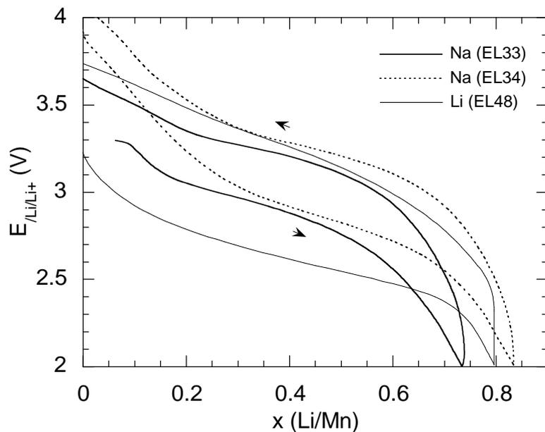
figure II.27: courbes de décharge à  $10\text{mV}\cdot\text{h}^{-1}$  des phyllomanganates de sodium et de lithium en fonction du taux d'insertion en lithium ( $\Delta x$ ) (premier cycle complet).
