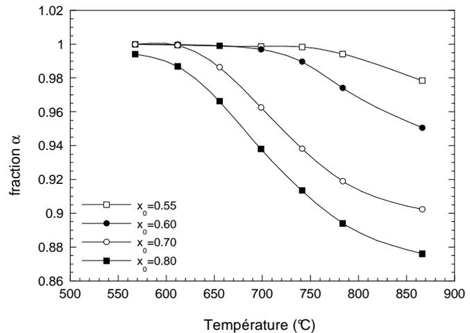
L'intégrité du système jusqu'à 870°C a été vérifiée par diffraction des rayons X. Les résultats des affinements de structure (méthode de Rietveld) sont présentés dans le tableau suivant:
