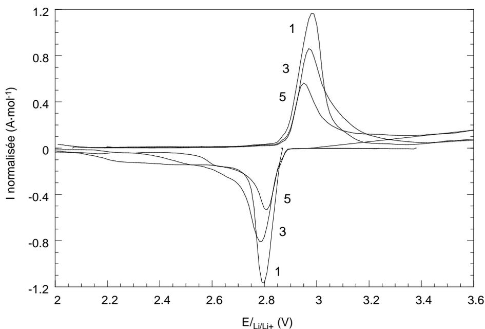
figure IV.18: voltampérométrie de " $\text{LiAlMnO}_4$ " en électrolyte liquide ( $25^\circ\text{C}$ ,  $m = 55.17\text{mg}$ , vitesse de balayage:  $10\text{ mV}\cdot\text{h}^{-1}$ ). Le numéro du cycle est indiqué.
