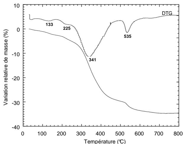
figure III.12: thermogramme du mélange de carbonates ( $Li/Mn=0.5$ ) à  $1^{\circ}C \cdot min^{-1}$  sous oxygène.
