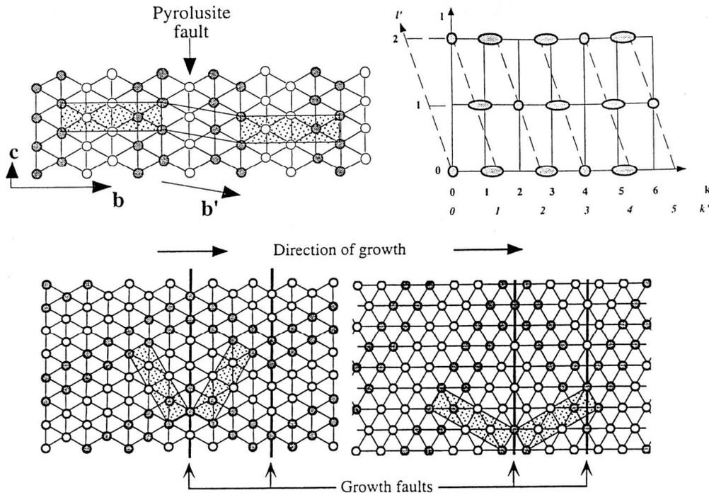
Figure II-1a,b: représentation (a) du désordre de De Wolff, (b) du micromaclage suivant les plans  $[061]$  et  $[021]$  dans  $\gamma\text{MnO}_2$  riche en ramsdellite (maille  $Pbnm$ )<sup>36</sup>.
