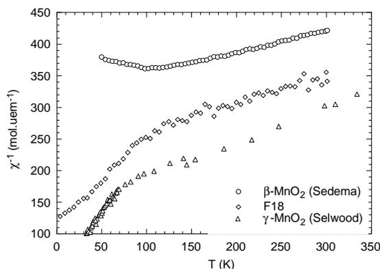
Fig. II.10. Comportement magnétique de  $\beta$ - $\text{MnO}_2$ , la 'ramsdellite synthétique' (échantillon F18) et un  $\gamma$ - $\text{MnO}_2$  de type 'CMD' (Selwood <sup>41</sup>)
