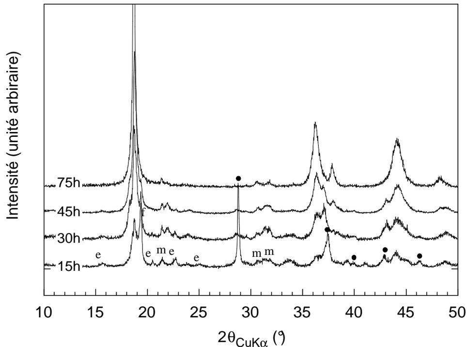
figure III.17: diagrammes de diffraction RX réalisés sur l'échantillon C85 ( $x_0 = 0.80$ ) à différentes étapes du traitement thermique à 200°C: de bas en haut: 15h, 30h, 45h, 75h. Le rapport  $x$  calculé pour le spinelle stœchiométrique final est de l'ordre de 0.56. Autres phases présentes: ●  $\beta\text{-MnO}_2$ , m  $\text{Li}_2\text{CO}_3$ , e phase "intermédiaire".
