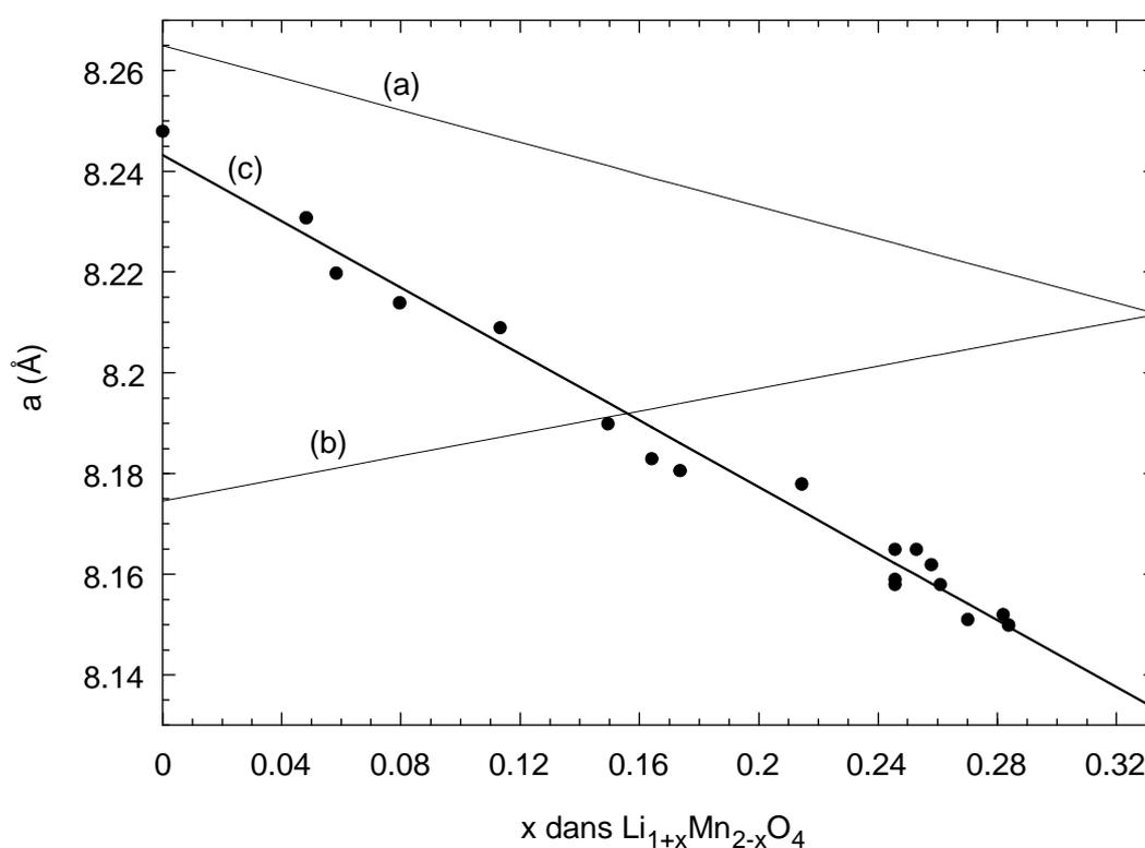
figure IV.5: évolution du paramètre de maille des spinelles Li-Mn-O cubiques et stœchiométriques: (•) données expérimentales, (a) distances O-M théoriques avec  $Mn^{3+}$  haut spin, (b) distances O-M théoriques avec  $Mn^{3+}$  bas spin, (c) distances O-M affinées.
