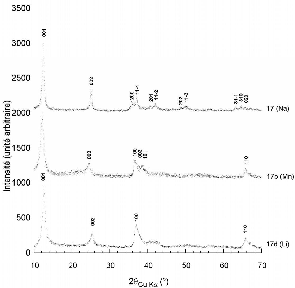
figure II.19: diagrammes de diffraction X des échantillons 17(Na), 17b(Mn) et 17d(Li)
