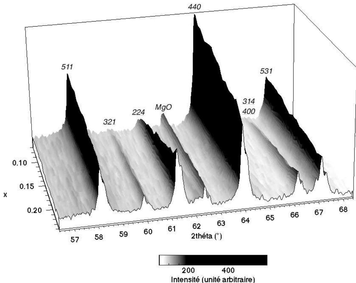
figure III.43: évolution du diffractogramme de l'électrode positive au cours de la recharge ( $x$  correspondant à la composition  $\text{Li}_{1+x}\text{Mn}_2\text{O}_4$ ). Indices non soulignés,  $\text{LiMn}_2\text{O}_4$ , indices soulignés  $\text{Li}_2\text{Mn}_2\text{O}_4$ .
