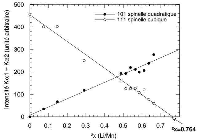
figures III.51a,b: (a) évolution du diffractogramme autour de la réflexion 111 du spinelle cubique et (b) mesure des intensités diffractées en fonction du taux d'insertion de lithium.
