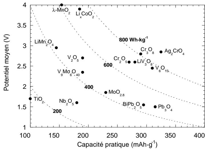
Figure I-5: : performances de divers oxydes en termes de capacité massique, potentiel moyen d'électrode par rapport à  $\text{Li}/\text{Li}^+$ , et densité d'énergie correspondante (d'après <sup>1</sup>).
