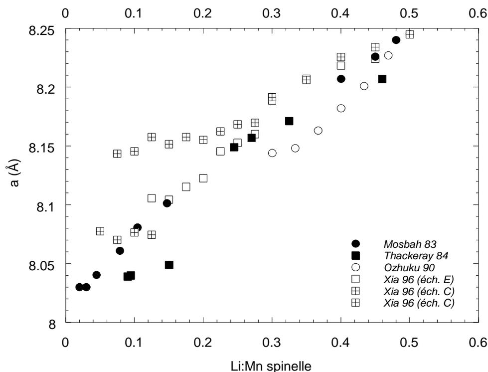
figure III.2: évolution du paramètre de maille en fonction de  $x = \text{Li:Mn}$  dans  $\text{Li}_{1+\Delta}\text{Mn}_2\text{O}_4$  pour des échantillons délithiés chimiquement<sup>22,23</sup> ou électrochimiquement<sup>9,24</sup>.
