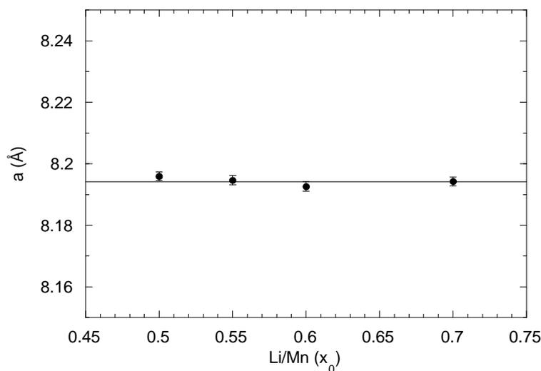
figure III.20: paramètre de maille de spinelles formés à partir de mélanges  $\beta\text{-MnO}_2\text{-Li}_2\text{CO}_3$  de différentes compositions à  $300^\circ\text{C}$  (2 semaines, lit fixe) sous  $\text{O}_2$ , puis trempés.
