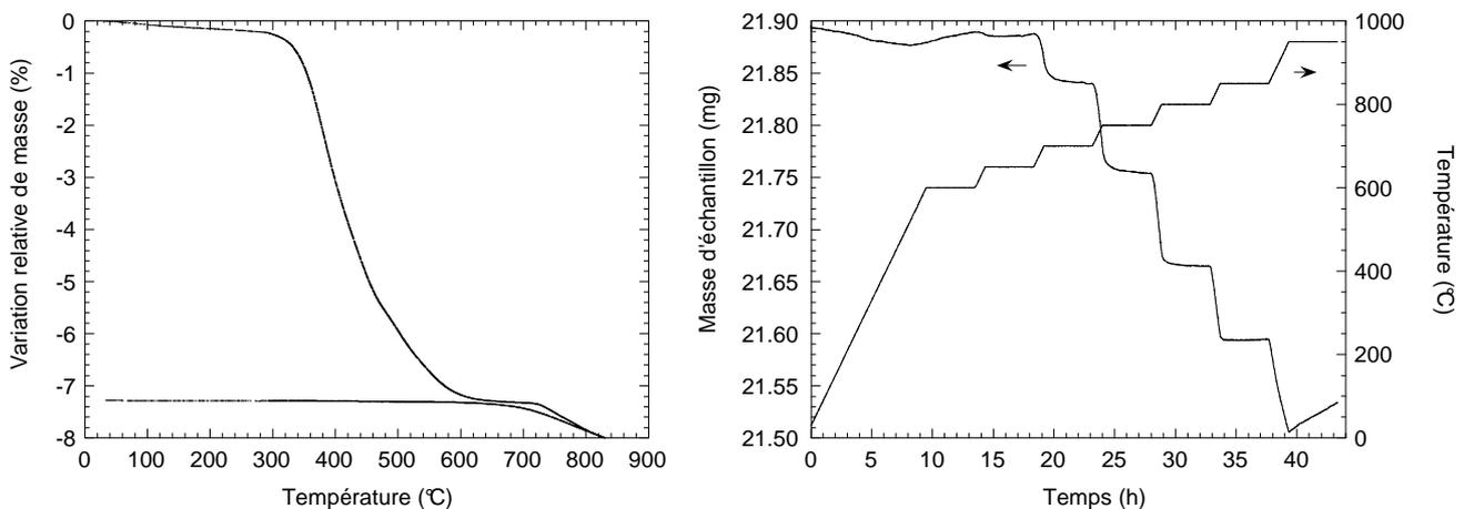
figures 26a,b: résultats d'un cycle lent à 0.2°C·min<sup>-1</sup>, suivi d'une remontée en température comprenant des paliers de 4h sur un échantillon  $x_0=0.70$
