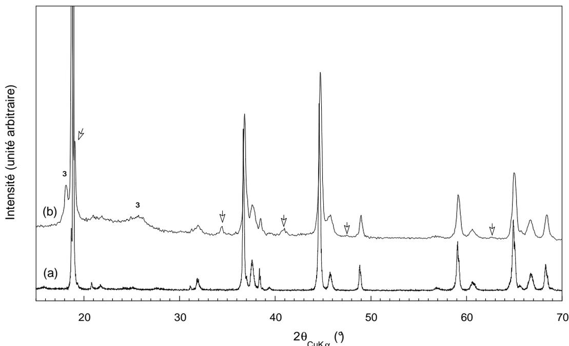
figure IV.21: modification des diffractogrammes RX de  $\text{LiAlMnO}_4$  provoquée par l'insertion du lithium: (a) composé initial, (b) après réduction jusqu'à 2.0 V et insertion de  $0.39 \text{ Li}^+/\text{Mn}$  (EL45).  $\downarrow$  phase quadratique,  $\diamond$  contribution du mélange cathodique.
