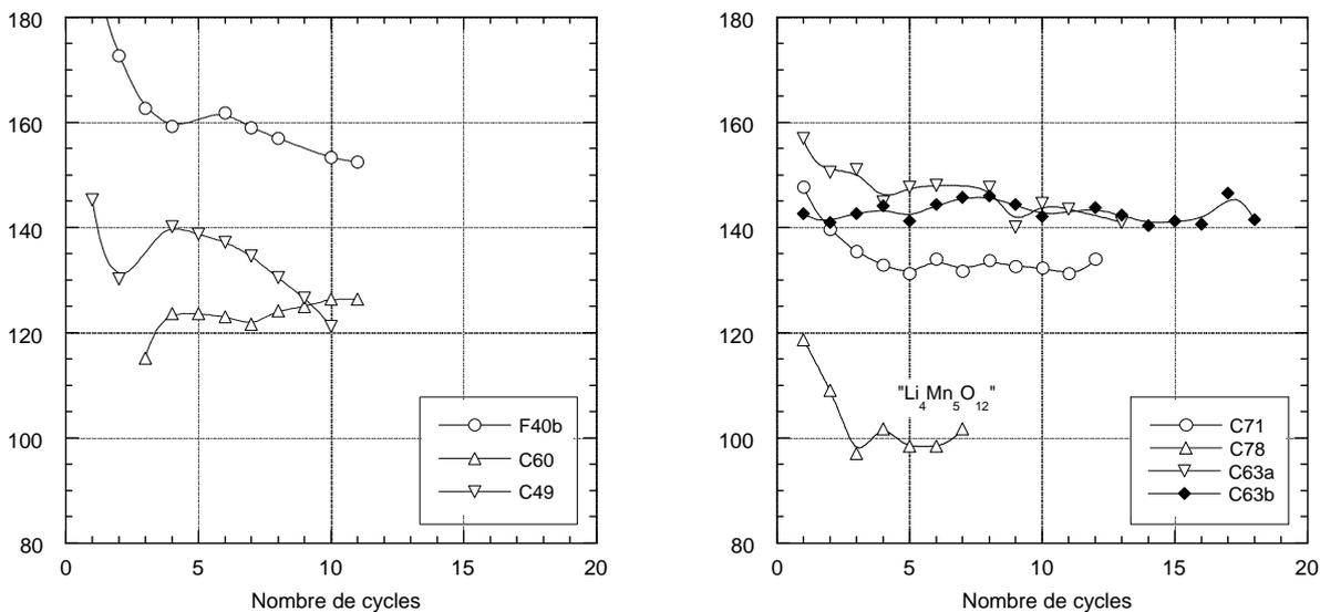
figures III.34a,b: évolution de la capacité en cyclage pour différents spinelles.
