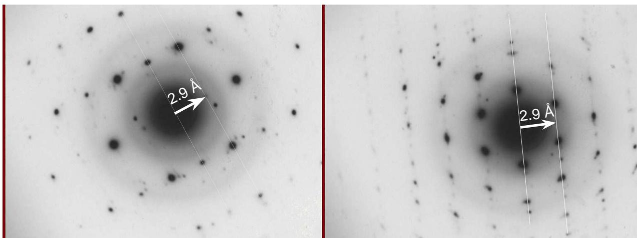
figures II.8a,b: diagrammes de diffraction électronique révélant la présence systématique de la distance inter-réticulaire de  $2.9\text{ \AA}$  perpendiculairement à l'axe des cristaux.
