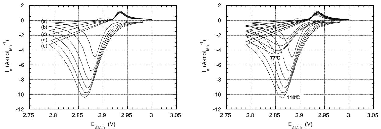
figures III.36a,b: comportement cinétique en décharge d'un échantillon Li/Mn = 0.71 (C79k) à vitesses de balayage et températures différentes: a:25, b:50, c:75, d: 125, e:150  $\text{mV} \cdot \text{h}^{-1}$ . Recharge à 5  $\text{mV} \cdot \text{h}^{-1}$ .
