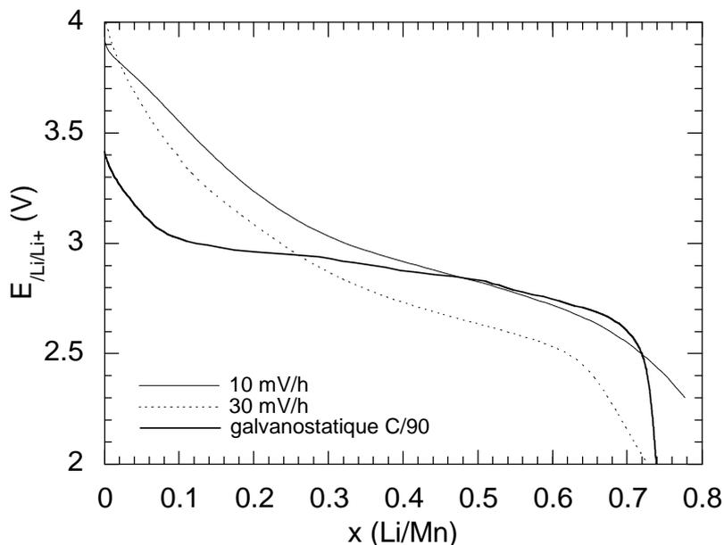
figure II.29: courbes de décharge du phyllomanganate de sodium entre 2 et 4 V pour différentes vitesses d'insertion.
