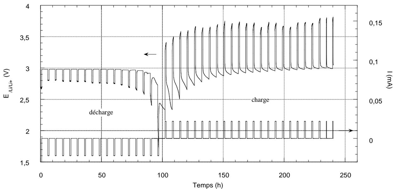
figure III.41: évolution du potentiel et de l'intensité imposée successivement au cours de l'insertion puis de la désinsertion de  $Li^+$  dans  $LiMn_2O_4$ .
