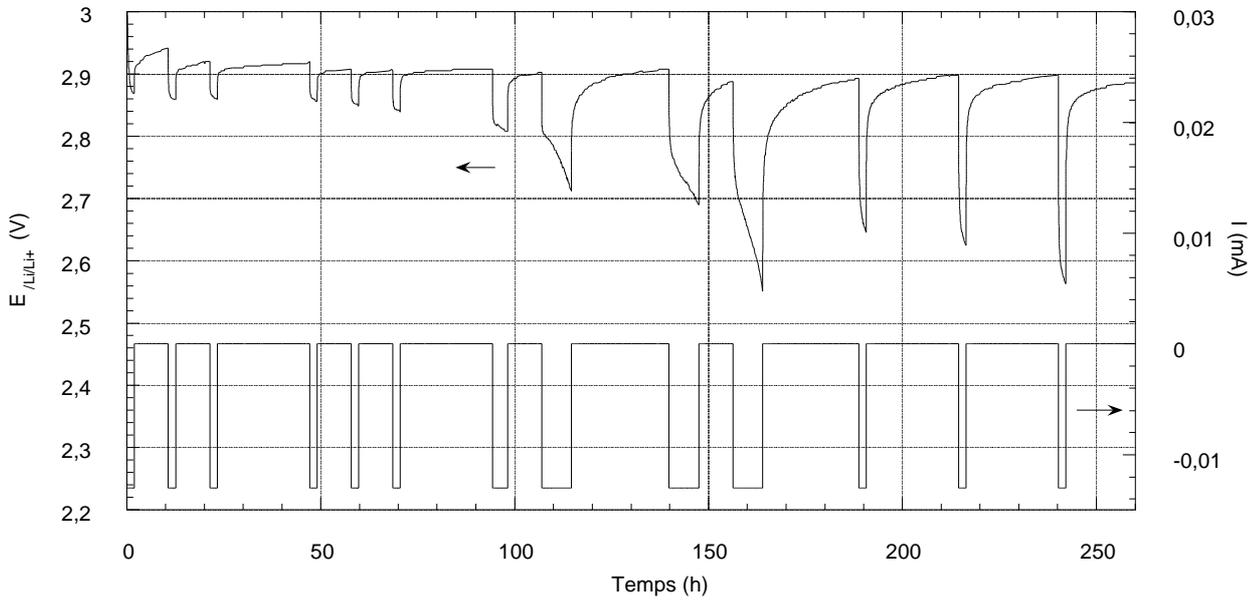
figure III.50: diagramme montrant l'évolution du potentiel au cours de la décharge, ainsi que la durée des étapes de relaxation.
