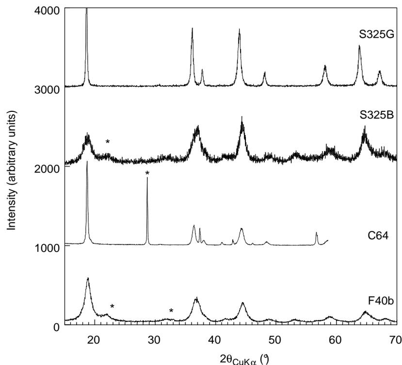
figure III.13. diffractogrammes d'échantillons typiques de  $Li/Mn$  initial = 0.5: F40b: ex carbonates, 400°C; C64: ex  $\beta$ -MnO<sub>2</sub>, 400°C; S325B: ex  $\gamma$ -MnO<sub>2</sub>, 400°C; S325G: ex  $\gamma$ -MnO<sub>2</sub>, 650°C; \* réflexions des réactifs de départ.
