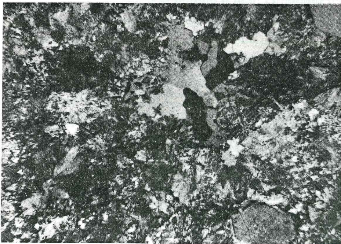
Fig.90b: rhyolite à mésostase à sphérolites (lame ZVo1). Galet dans les Grès d'Annot ouest-Argentera.
