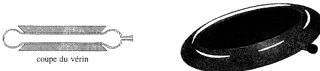
Figure II.3 : Vues du vérin plat sous pression
