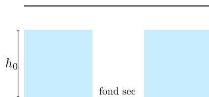
FIGURE 2.30 – État initial : double rupture
