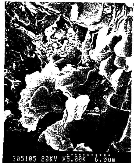
Gabbro ouralitisé fortement altéré. Extrait à une profondeur de 5 m dans le profil d'altération.
