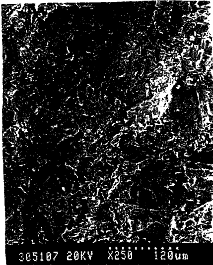
Gabbro ouralitisé fortement altéré. Extrait à une profondeur de 5 m dans le profil d'altération.
