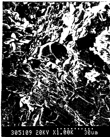
Gabbro moyennement altéré. Extrait à une profondeur de 12 m dans le profil d'altération.
