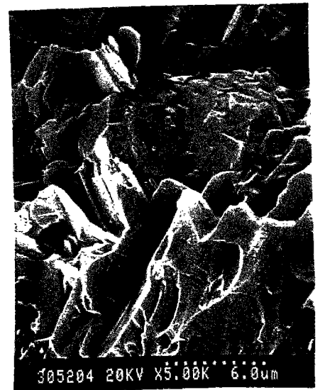
Gabbro sain. Extrait au dessous de la limite du profil d'altération dans l'exploitation récente
