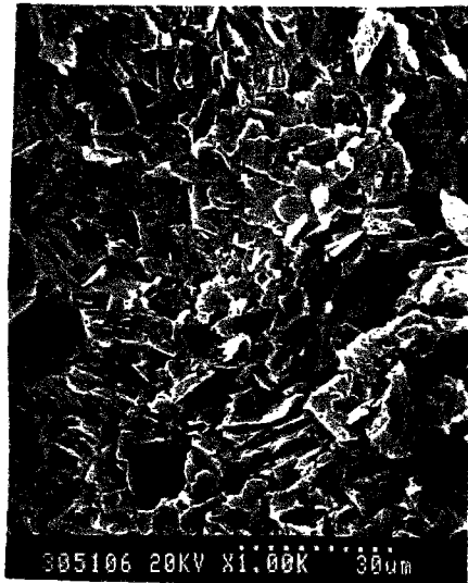
Gabbro ouralitisé fortement altéré. Extrait à une profondeur de 5 m dans le profil d'altération.
