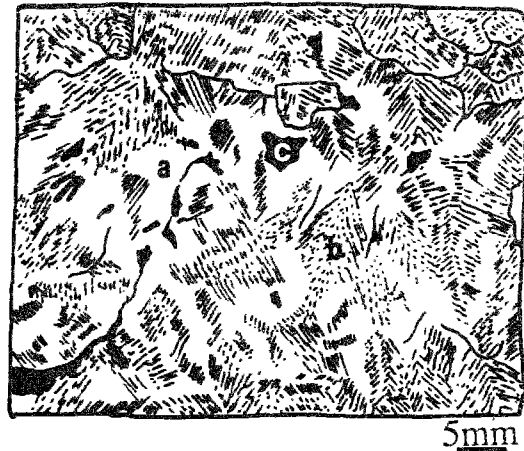
Figure 14 : Cliché photographique et représentation schématique montrant l'état initial avant essai de la face dessus de l'échantillon L3 de sel laiteux du Bassin Bressan. a: halite limpide; b: halite laiteuse; c: matrice carbonatosulfatée
