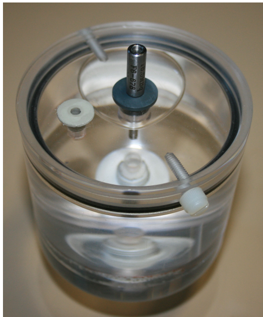
FIGURE 7.11 – Fantôme mini-deluxe rempli d'eau, embarquant au centre la source ponctuelle de ^{68}\text{Ge}
