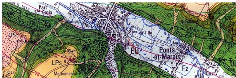
**Fig.E2.** Eu se situe dans la vallée de la Bresle qui entaille le plateau calcaire (craies du Crétacé). Le plateau est couvert de limons. Les alluvions Fz sont la seule source locale de granulat.
