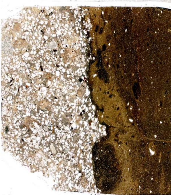
**Fig.I.26.** Lame mince conservant le mortier de chaux et de sable (à gauche) et la brique (à droite), échantillon CPA 15 (cryptoportique d'Arles).
