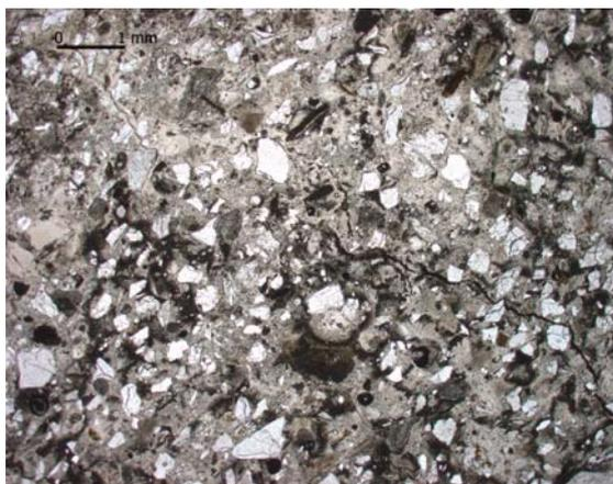
**Fig.K19a.** Vue générale du mortier CPA 13, type CPA-MS1. LPNA.
