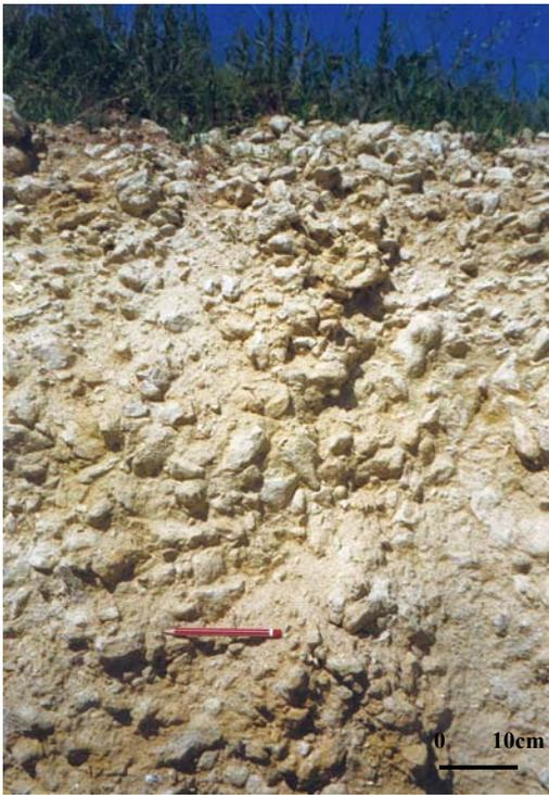
**Fig.J9.** Niveau d'altération sus-jacent à la formation saine du calcaire du Lutétien : cailloutis centimétriques (le « cron »).
