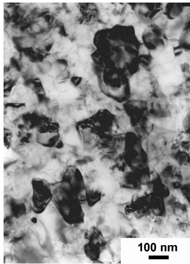
Fig. 4.1 : Champ clair montrant la structure ultrafine d'un alliage AlMgSi hyperdéformé par HPT [NUR 08]
