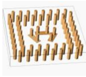
Figure I-19 : filtre d'ordre 3 réalisé en LTCC [I.39]
