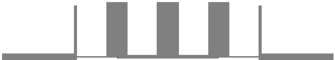
Figure I-8 : masque d'un filtre d'ordre 5 à stubs
