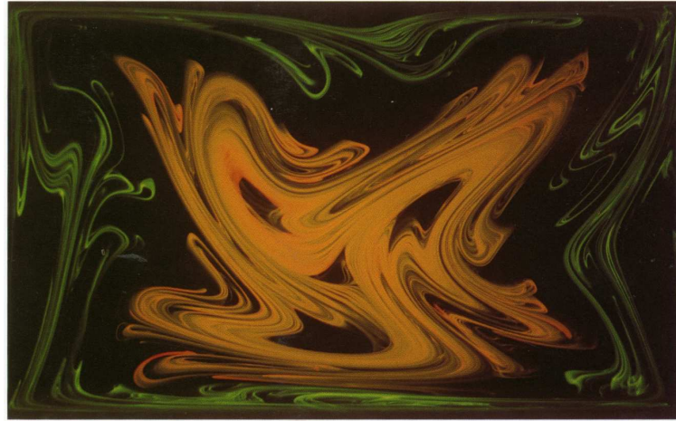
FIG. 1.21 – État du mélange de deux marqueurs au bout de 20 périodes dans la chambre d'advection chaotique avec parois mobiles. Pour cette expérience, Re = 1.2 et les parois sont co-directionnelles. À l'instant t = 0 , les traceurs n'étaient que deux petites taches orange et verte : on note bien pour t > 0 les nombreux étirements et replis réalisés par le mélangeur. On peut remarquer que pour ce jeu de paramètres, les deux traceurs ne se mélangent pas bien. Par contre, on pourrait montrer, en augmentant légèrement le temps de déplacement des rubans pendant chaque période, que le mélange pourrait être bien meilleur. D'après J.M. Ottino [4].
