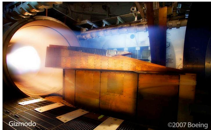
FIGURE 1.2: Vue d'un montage expérimental de test d'un moteur de type scramjet (Boeing).
