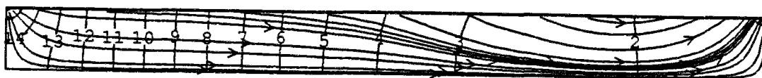
Figure A.7.20. : Vue en plan des équipotentiels et des lignes de courant dans une structure réservoir avec drain, à T = 30 \text{ minutes} ( H_{\text{nivel}} = 1 \text{ mm} , pente = 0 %, K = 10 \text{ cm/s} , n = 30 \% ).
