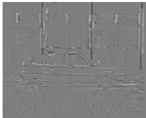
(b) résidu avec compensation de mouvement (blocs de taille 16 \times 16 ).
