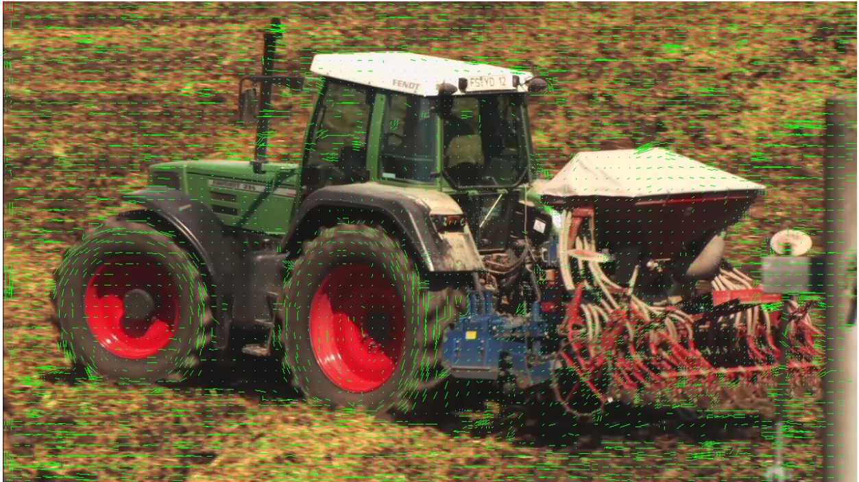
FIG. 3.6 – Vecteurs de mouvement obtenus pour une image extraite de la séquence vidéo Tractor avec l'estimation de mouvement classique du codeur H.264.
