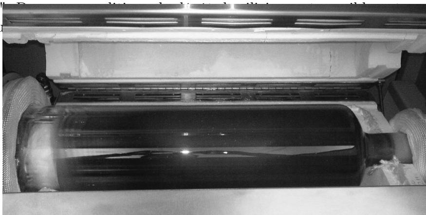
FIGURE 2.5 – Dépôt de silicium opaque sur la paroi interne du tube en quartz du réacteur EasyWire.
