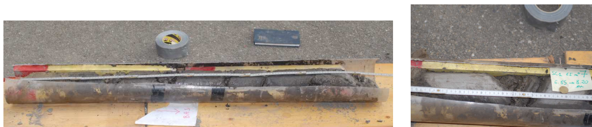
FIG. 4.9 – Gauche : Exemple de carotte, lors de l’ouverture de la gaine plastifiée. La présence de boue en surface montre que l’humidité a été préservée. Droite : Partie de la carotte montrée à gauche, lorsque fois que la boue a été retirée.
