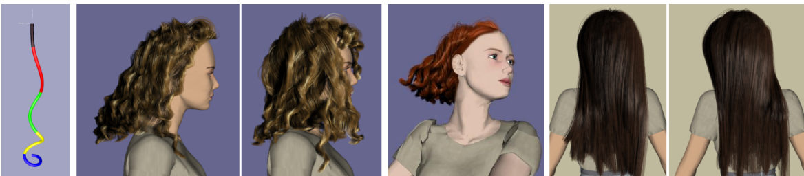
FIG. 7.1: À gauche : une Super-Hélice. Au centre et à droite : simulation dynamique d'une chevelure ondulée, bouclée et lisse. Ces chevelures ont été animés en utilisant une centaine de cheveux guide, chaque cheveu guide étant une Super-Hélice composée de N = 5 éléments hélicoïdaux.
