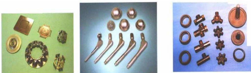
Figure 3 : Exemples de pièces miniatures obtenues par micro-formage [RAJ 05].
